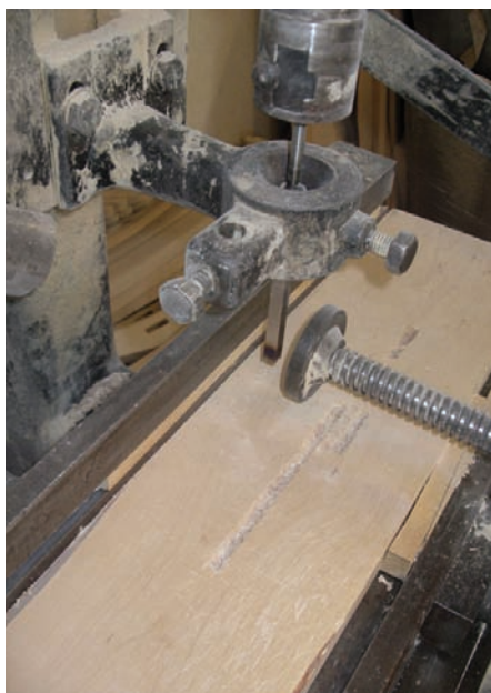
Den eldste maskina i verkstedet er en hylsestemmer som har vært med fra den tida bygget ble reist omtrent. Bildet viser en slags "bor" som lagde firkanthull i den ene av de delene som skulle føyes sammen
