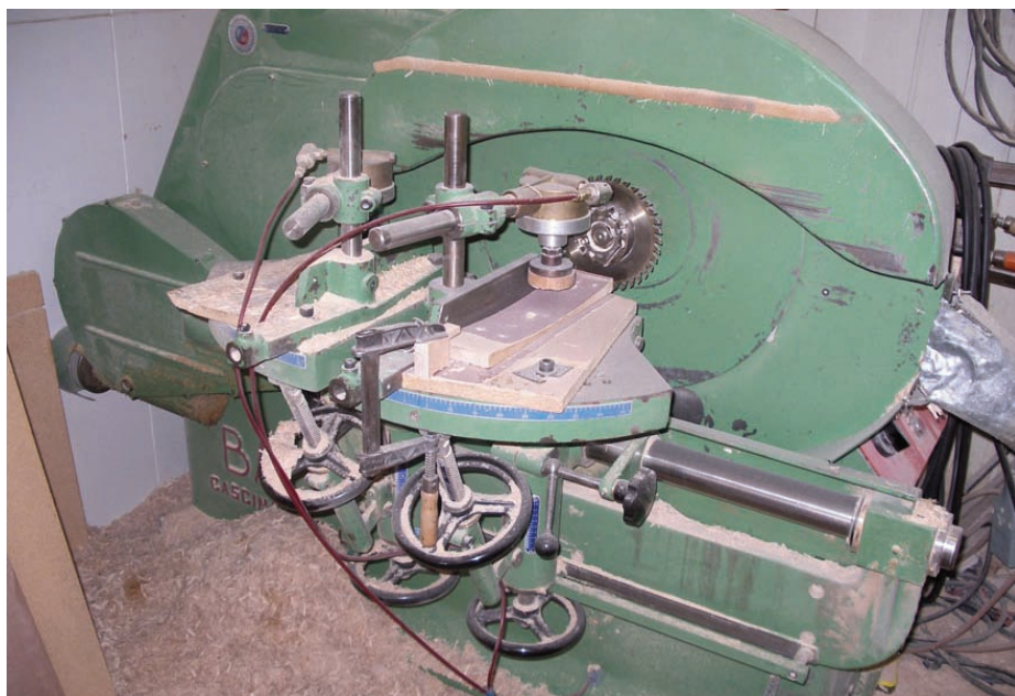
Denne maskina lager taper for å "føye sammen" de forskjellige møbeldelene
