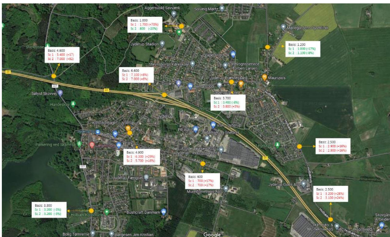
Figur 4 viser hvordan ændringen i trafik ser ud i forhold til dagens trafik (Basis). De trafikale ændringer er både en effekt af byudvikling og påvirkningen af Kalundborgmotorvejen.
