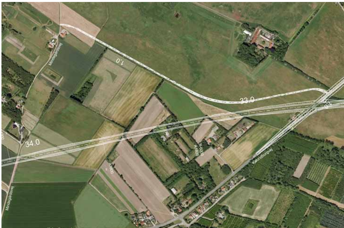
FIGUR 4.13 Kalundborgvej føres over motorvejen og den ny adgangsvej mellem Kalundborgvej og Mindegårdsvej i hovedforslaget
