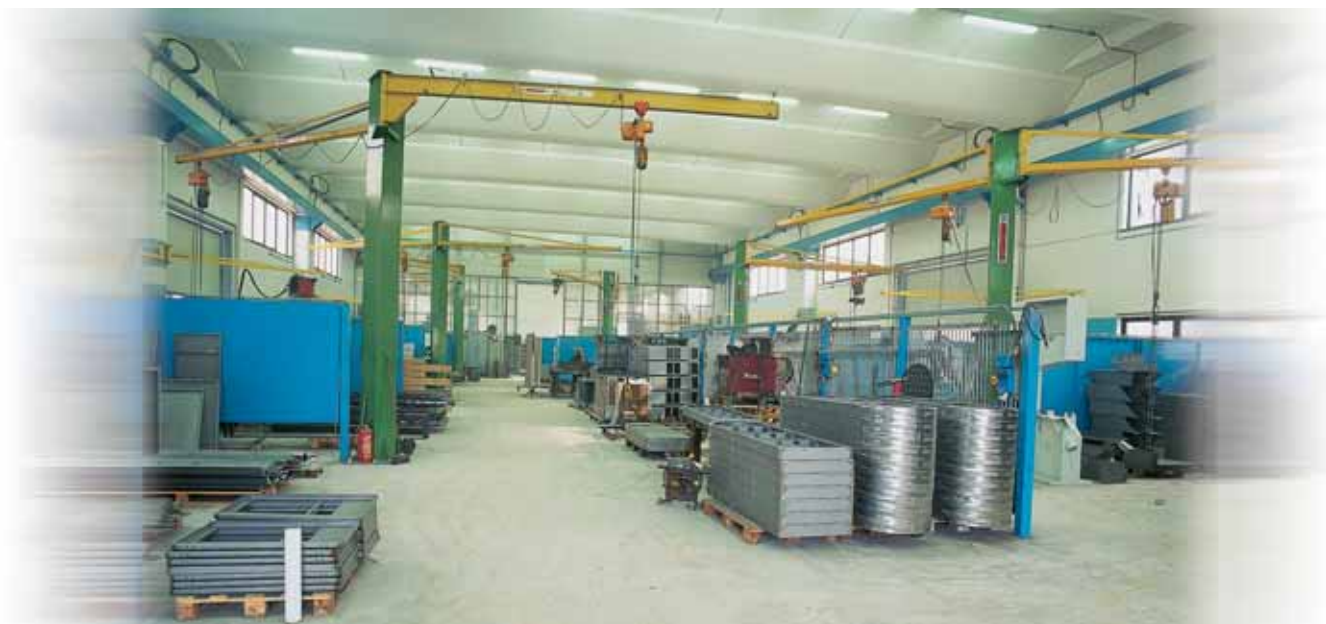
Gru a bandiera a colonna con due bracci. Column-mounted jib crane with two jibs. Potence à colonne avec deux flèches. Säulen-Auslegerkran mit zwei Armen.
