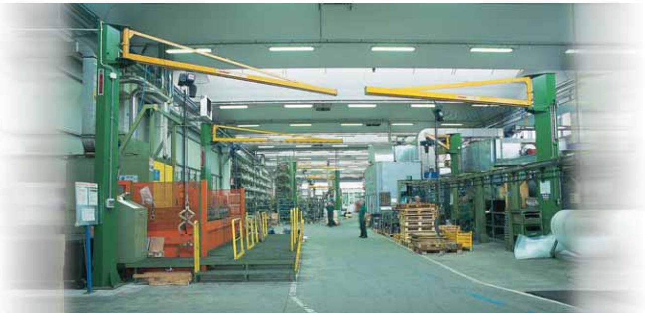
Gru a bandiera a colonna con braccio profilato in canalina. Column-mounted jib crane with channel-type structural steel arm. Potence à colonne avec flèche en profilé creux à glissière. Säulen-Auslegerkran mit Führungskanal-Profilarms.
