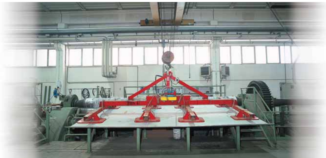
Ventosa tipo GLA8F a otto piastre - portata kg 4.000. GLA8F type eight-plate vacuum grab - 4.000 kg capacity. Palonnier type GLA8F à huit ventouses - portée 4.000 kg. Saugnapf Typ GLA8F mit acht Platten, Tragfähigkeit 4.000 kg.
