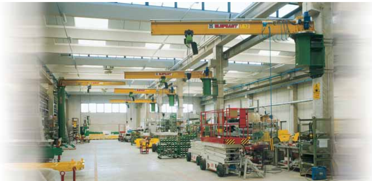
Gru a bandiera a colonna e a mensola con rotazione elettrica a 360°. Jib crane, column-mounted and bracket-mounted with 360° power rotation. Potence à colonne et murale avec rotation électrique à 360°. Säulen- und Konsol-Auslegerkran mit elektrischer Rotation um 360°.
