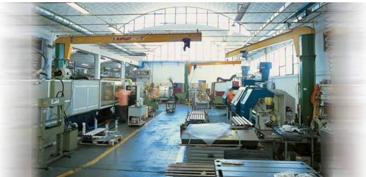
Gru a bandiera a colonna con rotazione manuale a 360°. Column-mounted jib crane with 360° manual rotation. Potence à colonne avec rotation manuelle à 360°. Säulen-Auslegerkran mit manueller Rotation um 360°.
