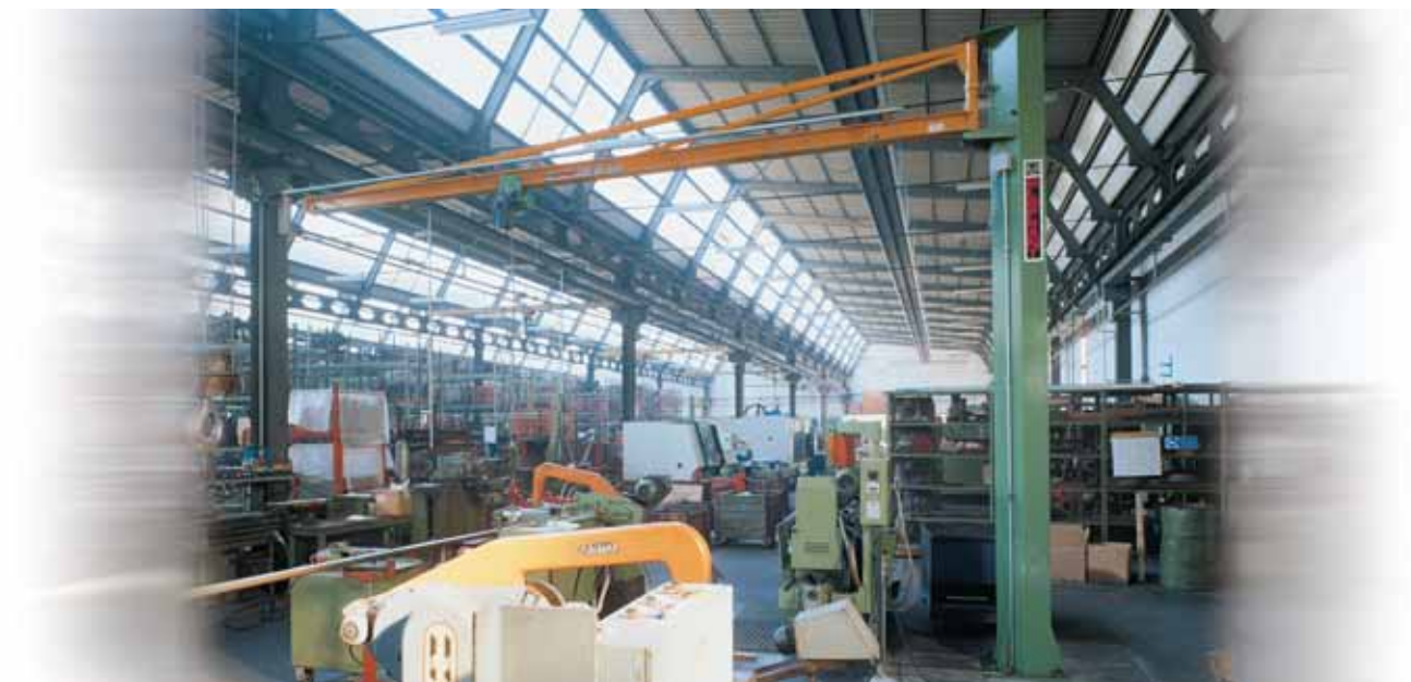
Gru a bandiera a colonna con braccio in trave tirantata. Column-mounted jib crane with tie-rod girder arm. Potence à colonne avec flèche à poutre à tirant. Säulen-Auslegerkran mit Zugstangenträgerarm.
