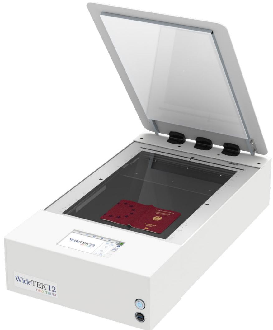
*WideTEK® 12 SPECTRUM für die Echtheitsprüfung von Banknoten, Pässen, ID-Karten, Zertifikaten und anderen speziellen Objekten mit Sicherheitsmerkmalen. Erfasst die Fluoreszenz von UV-aktiver Tinte und anderen Objekten bei 365nm UV-Licht. Scannt den IR-Kontrast von Dokumenten bei 850nm IR-Licht.*
