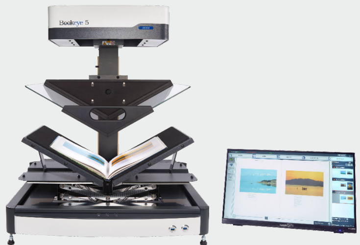
Scannen von hochglänzenden Vorlagen mit V-Glasplatte
