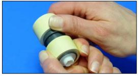
als bei den Einzugsrollenbelägen (*Kapitel 7.2.2.*), ist es notwendig, die Beläge mit dem Daumen rundherum, nach außen über den Wulst des Kunststoffträgers zu drücken, bevor sie seitlich heruntergezogen werden können. Beim Aufschieben der neuen Beläge (*Kapitel 3.1.*) ist darauf zu achten, dass sie auf der Rolle komplett in den Führungen liegen. Der Einbau der Trennrolle erfolgt wiederum wie im vorherigen Kapitel beschrieben.
