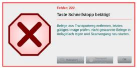
Diese Meldung wird angezeigt, wenn am Belegeinzug die rote Taste *Schnellstopp* (Kapitel 5.6.2.) gedrückt wurde. In diesem Fall ist der Grund für den Schnellstopp zu beseitigen und vor erneutem Scanstart, gemäß generellem Papierstau-Handling (Kapitel 9.2.) zu verfahren.
