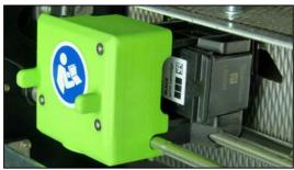
Bei der ebenfalls erhältlichen HD-Variante der Imprinter werden Tintenpatronen des Typs *HP337* (*Hersteller-Nr. C9364E*) verwendet. Die Halterung dieses Imprintertyps verwendet das SnapIn-Verfahren, das auch bei herkömmlichen HP-Druckern üblich ist. Die grüne Haube oberhalb der Halterung verdeckt eine Steuerplatine, die zur Nutzung des *Imprinter HD* nötig ist.
