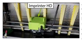
Alle Imprinter-Varianten, welche die Informationen *nach* dem Scan aufdrucken, haben, aufgrund ihrer Anbringung ebenfalls vorgegebene Positionsrasten auf der hinteren Führungsstange, damit der Imprinter immer so positioniert wird, dass der Druck nicht versehentlich auf eines der Transportbänder (*Rückseite*) oder nicht genau durch die vorgegeben Stanzungen im Leitblech (*Vorderseite*) erfolgt.
