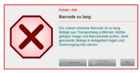
Dieser Fehler tritt auf, wenn beim genutzten Scan-Profil eine *Barcode-Erkennung* (*Kapitel 4.6.4.4.*) aktiv ist und der erkannte Barcode auf dem aktuellen Beleg die zugelassene Länge von 16 Zeichen überschreitet. Zum Beheben des Fehlers ist vor erneutem Scanstart gemäß generellem Papierstau-Handling (*Kapitel 9.2.*) zu verfahren und der betroffene Beleg mit dem Barcode zu prüfen.
