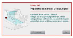
Dieser Fehler signalisiert einen Papierstau, der im Bereich der hinteren Belegausgabe aufgetreten ist. Um den Fehler zu beheben, ist gemäß generellem Papierstau-Handling (*Kapitel 9.2.*) zu verfahren. Hierzu kann es nötig sein, das Scanoberteil anzuheben (*Kapitel 6.1.*), bis das gestaute Belegmaterial aus der Scanebene entfernt werden kann. Unter Umständen muss auch die Andruckeinheit hintere Belegausgabe entnommen werden (*Kapitel 6.5.*).
