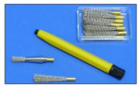
Da die Borsten während der Reinigung verschleißen, ist es nötig, dass die Länge immer wieder nachgestellt wird. Ist der Bürsteneinsatz verbraucht, muss er durch einen neuen ersetzt werden. Dazu wird die Stiftspitze abgeschraubt, und der verbrauchte Borsteneinsatz aus der Halterung im Stiftinneren gezogen. Nun einen neuen Borsteneinsatz zuerst von vorne durch die Stiftspitze schieben bevor er in die Halterung gedrückt wird und die Spitze wieder festschrauben.
