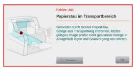
Dieser Fehler signalisiert einen Papierstau, der im Transportbereich aufgetreten ist. Damit wird der Bereich zwischen Scanebene und Belegausgabe bezeichnet. Um den Fehler zu beheben, ist gemäß generellem Papierstau-Handling (*Kapitel 9.2.*) zu verfahren. Hierzu kann es nötig sein, das Scanoberteil anzuheben (*Kapitel 6.1.*), bis das gestaute Belegmaterial aus Scanebene und Transportbereich entfernt werden kann. Nach Schließen
