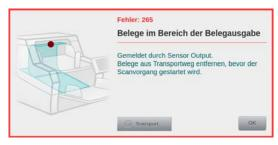
Dieser Fehler signalisiert, dass ein Scanvorgang gestartet wurde, obwohl sich Belege im Bereich der Belegausgabe des Scanners befinden. Dies geschieht, wenn nach vorangegangenem Fehler dieser Bereich nicht freigeräumt wurde. Um den Fehler zu beheben, ist vor erneutem Scanstart, gemäß generellem Papierstau-Handling (*Kapitel 9.2.*) zu verfahren. Wird damit der Fehler nicht behoben, kann dies auch auf hängengebliebene Pa-
