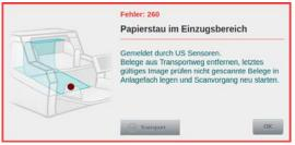
Dieser Fehler signalisiert einen Papierstau, der im Einzugsbereich aufgetreten ist. Dies ist der Fall, wenn ein Beleg von der Einzugsrolleneinheit nicht ordnungsgemäß eingezogen werden konnte. Um den Fehler zu beheben, ist gemäß generellem Papierstau-Handling (Kapitel 9.2.) zu verfahren. Hierzu kann es nötig sein, das Scanner-Oberteil soweit zu öffnen (Kapitel 6.1.), bis das gestaute Belegmaterial aus dem Einzugsbereich entfernt
