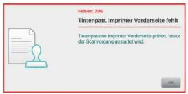
Diese Fehler werden nur angezeigt, wenn für die geladene Scannereinstellung ein Drucktext für einen der Imprinter definiert wurde und dessen Tintenpatrone nicht verfügbar ist Um den jeweiligen Fehler zu beseitigen, muss der richtige Sitz der betreffenden Tintenpatrone geprüft werden (*Kapitel 8.3.1.*), bevor der Scanvorgang erneut gestarten werden kann.
