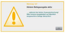
Diese Warnung wird in Folge eines Papierstaufehlers angezeigt, wenn zum Zeitpunkt des Papierstaus die Weiche zum hinteren Ausgabefach geöffnet war. Da zur ordnungsgemäßen Behebung eines Papierstaus nach dem generellem Papierstau-Handling (*Kapitel 9.2.*) zu verfahren ist, soll mit dieser Warnung darauf hingewiesen werden, dass Belege beim Leeren des Transportweges, durch die geöffnete Weiche fälschlicherweise in das hintere Ausgabefach ausgeworfen werden könnten.
