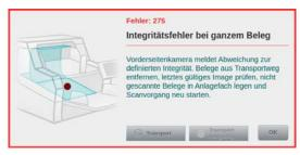
Dieser Fehler wird angezeigt, wenn im verwendeten Scanprofil die *Belegintegritäts-Erkennung* aktiviert (*Kapitel 4.6.4.7.*) und ein Beleg während des Scannens als *nicht integer* erkannt wurde. Um den Fehler zu beheben, ist gemäß generellem Papierstau-Handling (*Kapitel 9.2.*) zu verfahren, bevor der Scanvorgang erneut gestartet wird.
