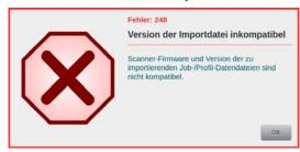
Dieser Fehler wird angezeigt, wenn beim Importieren von Scan-Jobs/-Profilen (*Kapitel 4.7.6.2.*) auf dem Stick eine Datei ist, welche exportierte Scan-Jobs/-Profile enthält, die mit der vorhandenen Firmware-Version des Scanners nicht kompatibel ist. Im Zweifelsfall kann der Software-Support der *InoTec* kontaktiert werden.
