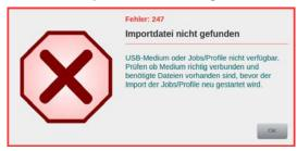
Wenn beim Importieren von Scan-Jobs/-Profilen, Kamerakurven oder ICC-Profilen (*Kapitel 4.7.6.2./4.7.6.5./4.7.6.6.*) der USB-Stick nicht gefunden oder nicht gelesen werden kann, bzw. auf dem Stick keine Datei ist, welche die entsprechenden Daten enthält, wird dieser Fehler angezeigt. Bitte prüfen, ob der USB-Stick an einem der USB2-Anschlüsse richtig eingesteckt ist und eine Exportdatei mit den zu importierenden Daten enthält.
