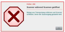
Dieser Fehler wird angezeigt, wenn am Gerät während des Scanvorganges die Scanebene geöffnet wurde oder diese bei Scanstart nicht richtig geschlossen war. Um den Fehler zu beheben, muss die Scanebene ordnungsgemäß geschlossen werden (*Kapitel 6.1.*). Vor erneutem Scanstart müssen alle Belege entfernt werden, die sich eventuell noch im Transportweg befinden, da es sonst zu Folgefehlern kommt.
