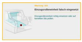
Diese Warnung wird initial nur im Statusbereich angezeigt und bedeutet, dass die Einzugsrolleneinheit nicht korrekt eingebaut wurde. Um die Warnung zu beseitigen, muss geprüft werden, ob die Einzugsrolleneinheit richtig in ihrer Halterung sitzt (*Kapitel 7.2.1.*). Wird in diesem Status versucht, einen Scanvorgang zu starten, erhält man eine ähnlich lautende Fehlermeldung (*Kapitel 9.2.2.*).
