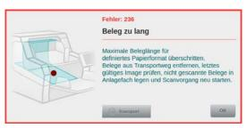
Dieser Fehler tritt auf, wenn Längenkontrolle aktivieren (Kapitel 4.6.7.5.) gewählt wurde und der gescannte Beleg die Durchlauflänge des definierten Papierformates (Kapitel 4.6.3.1.1.) überschritten hat. Dies kann, je nach Einstellung der Ausrichtung (Kapitel 4.6.3.4.), auch die Breite des Formates sein. Um den Fehler zu beheben, ist vor erneutem Scanstart, gemäß generellem Papierstau-Handling (Kapitel 9.2.) zu verfahren.
