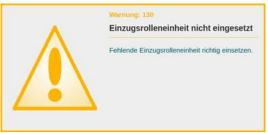
Diese Warnung wird initial nur im Statusbereich angezeigt und bedeutet, dass die Einzugsrolleneinheit nicht erkannt wurde. Um die Warnung zu beseitigen, muss die Einzugsrolleneinheit ordnungsgemäß in ihre Halterung eingesetzt werden (*Kapitel 7.2.1.*). Wird in diesem Status versucht, einen Scanvorgang zu starten, erhält man eine ähnlich lautende Fehlermeldung (*Kapitel 9.2.31.*).
