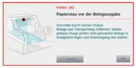
Dieser Fehler signalisiert einen Papierstau, der vor der Belegausgabe aufgetreten ist. Um den Fehler zu beheben, ist gemäß generellem Papierstau-Handling (*Kapitel 9.2.*) zu verfahren. Hierzu kann es nötig sein, das Scanoberteil (*Kapitel 6.1.*) oder die Abdeckung Belegausgabe anzuheben (*Kapitel 6.3.*), bis das gestaute Belegmaterial aus Transport- und Belegausgabebereich entfernt werden kann. Nach Schließen des Scanners kann der Scanvorgang erneut gestartet werden
