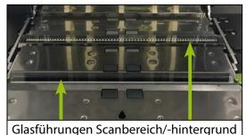
Die Scanbereiche für die Belegvorder- und -rückseite, sowie der jeweils zugehörige Scanhintergrund, sind mit Glasführungen aus sehr kratzfestem Industrieglas staubdicht abgedeckt. Daher reicht im Normalfall eine Oberflächenreinigung dieser Glasführungen mit dem mitgelieferten Swiffer® Duster Staubmagnet oder einem weichen Tuch. Sollten sich anhaftende Rückstände auf den Glasführungen befinden, sollten diese mit SCAMAX® Optikreiniger entfernt werden.
