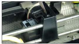
Beide verfügbaren Imprintertypen verwenden herkömmliche Tintenstrahl-Patronen von Hewlett Packard welche in verschiedenen Druckfarben erhältlich sind. Diese Tintenpatronen zeichnen sich durch hohe Ausfallsicherheit, leichte Handhabung und eine weltweite Verfügbarkeit aus. Die Tintenpatrone der *Imprinter SD* hat die Hersteller-Nr. *C6602A* und ist jeweils in einer gefederten Haltevorrichtung befestigt.
