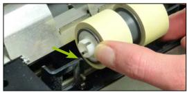
Zum Einbau, die Trennrolle mit den seitlichen Führungen wieder auf die Halterung schieben, die Trennrollenabdeckung zuklappen und mit leichtem Druck den Verschluss arretieren.
