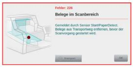
Dieser Fehler signalisiert, dass ein Scanvorgang gestartet wurde, obwohl sich Belege im Scanbereich des Scanners befinden. Dies geschieht, wenn nach vorangegangenem Fehler dieser Bereich nicht freigeräumt wurde. Um den Fehler zu beheben, ist vor erneutem Scanstart, gemäß generellem Papierstau-Handling (*Kapitel 9.2.*) zu verfahren. Wird damit der Fehler nicht behoben, kann dies auch auf hängengebliebene Papierschnipsel, Heftklammern
