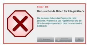
Dieser Fehler wird angezeigt, wenn im verwendeten Scanprofil die *Belegintegritäts-Erkennung* aktiviert (*Kapitel 4.6.4.7.*), aber nicht alle Kanten des Beleges erkannt wurden und somit eine ordnungsgemäße Integritätserkennung nicht möglich ist. Um den Fehler zu beheben, muss ein passendes *Papierformat* (*Kapitel 4.6.3.1.*) oder die richtige *Papieranlage-Ausrichtung* (*Kapitel 4.6.3.4.1.*) gewählt werden.
