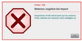
Soll ein Scan-Profil importiert werden (*Kapitel 4.7.6.2.*), bei dem bestimmte Einstellungen (*z. Bsp. Zähler*) auf ein anderes Profil referenziert sind, wird dieser Fehler angezeigt, wenn das Referenz-Profil nicht auf dem Scanner vorhanden ist. Um den Fehler zu umgehen, müssen zuerst solche Referenz-Profile erstellt oder importiert werden.
