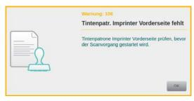
Diese Warnungen werden nur angezeigt, wenn für die geladene Scannereinstellung ein Drucktext für einen der Imprinter definiert wurde und dessen Tintenpatrone nicht verfügbar ist. Um die Warnung zu beseitigen, muss der richtige Sitz der jeweiligen Tintenpatrone geprüft werden (*Kapitel 8.3.1.*). Wird in diesem Status versucht, einen Scanvorgang zu starten, erhält man ähnlich lautende Fehlermeldungen (*Kapitel 9.2.3.*).
