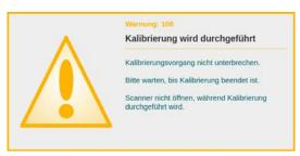
Diese Warnung bedeutet, dass sich der Scanner aktuell in einem Kalibrierungsvorgang befindet. In diesem Zustand darf das Gerät nicht geöffnet oder ausgeschaltet werden. Die Warnmeldung wird geschlossen, sobald die Kalibrierung beendet wurde. Ist die Kalibrierung fehlgeschlagen, erscheint eine entsprechende Fehlermeldung (Kapitel 9.2.8.).
