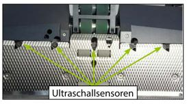
Da die Ultraschallsensoren für die Doppelblatterkennung im vorderen Bereich der Scanebene etwas vertieft angebracht sind, ist es speziell bei den unteren Sensoren wichtig, dass sie in regelmäßigen Abständen auf Ablagerungen geprüft und am einfachsten mit dem Staubpinsel (*Kapitel 3.1.*) davon befreit werden. Sind die Sensoren zu stark verschmutzt oder befinden sich Rückstände darauf, kann es vermehrt zu falschen Doppelblatterkennungen kommen.
