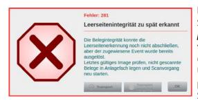
Dieser Fehler wird angezeigt, wenn im verwendeten Scanprofil die *Belegintegritäts-Erkennung* aktiviert (*Kapitel 4.6.4.7.*) wurde, das Ergebnis der Leerseitenintegrität aber zu spät erfolgte, um ein dafür aktives Ereignis (*bspw. Beleg nach hinten auswerfen*) noch auszuführen. Um den Fehler zu beheben, ist gemäß generellem Papierstau-Handling (*Kapitel 9.2.*) zu verfahren, bevor der Scanvorgang erneut gestartet wird.
