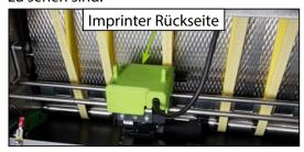
Der Imprinter Rückseite befindet sich an der Geräterückseite, unterhalb der hinteren Abdeckung (*Kapitel 6.4.*), die abgenommen werden muss, um Zugriff darauf zu erhalten.
