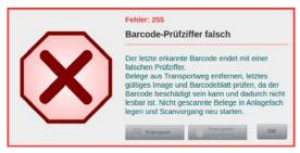
Dieser Fehler tritt auf, wenn beim genutzten Scan-Profil eine *Barcode-Erkennung* (*Kapitel 4.6.4.4.*) aktiv ist, der/ die dort ausgewählte(n) Barcodetyp(en) inkl. Prüfziffer erkannt wird/werden und die Prüfziffer des erkannten Barcodes auf dem aktuellen Beleg falsch ist. Zum Beheben des Fehlers ist vor erneutem Scanstart gemäß generellem Papierstau-Handling (*Kapitel 9.2.*) zu verfahren und der betroffene Beleg mit dem Barcode zu prüfen.
