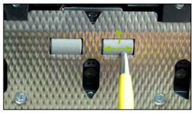
Für die Reinigung der Transportwalzen muss der Scanner angeschaltet und die Scanebene komplett geöffnet sein (*Kapitel 6.1.*). Wird nun die Taste *Start/Pause* musscanner gedrückt und gehalten, wird ein spezieller Reinigungslauf aktiviert und es erscheint eine entsprechende Meldung am Scannerdisplay (*Kapitel 9.1.9.*). Hierbei werden alle Transportwalzen in langsamer Geschwindigkeit entgegen der Einzugsrichtung bewegt. In diesem Modus, den Reinigungsstift oberhalb der
