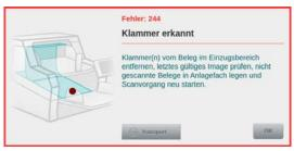
Dieser Fehler signalisiert, dass die Metalldetektoren im Einzugsbereich eine Klammer oder dergleichen erkannt haben. Um den Fehler zu beheben, ist der Metallgegenstand zu entfernen und gemäß generellem Papierstau-Handling (*Kapitel 9.2.*) zu verfahren. Hierzu kann es nötig sein, das Scanner-Oberteil soweit zu öffnen (*Kapitel 6.1.*), bis das gestaute Belegmaterial aus dem Einzugsbereich entfernt werden kann. Nach Schließen
