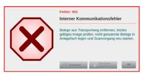
Wird eine Warn- oder Fehlermeldung angezeigt, deren Nummer größer als 800 ist, liegt ein unerwarteter Zustand vor. Bei einigen Fehlern sind Funktionstasten enthalten, die eine Durchführung des generellen Papierstau-Handlings (*Kapitel 9.2.*) zulassen. Anderenfalls muss der Scanner in diesem Fall neu gestartet werden. Kann der Zustand dadurch nicht behoben werden, ist der zuständige Servicetechniker oder der technische
