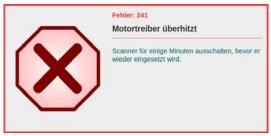
Dieser Fehler wird angezeigt, wenn am Gerät eine der Motorsteuerungsplatinen überlastet wird. Um den Fehler zu beheben, muss der Scanner für einige Minuten abgeschaltet werden. Zusätzlich kann vor erneutem Scanbeginn der Papiertransportweg auf Fremdkörper geprüft werden, die den Papiertransport erschweren könnten. Tritt der Fehler erneut auf, ist der zuständige Servicetechniker oder der technische Support der *InoTec* (*Kapitel 10.3.*) zu benachrichtigen.
