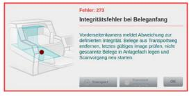
Dieser Fehler wird angezeigt, wenn im verwendeten Scanprofil die *Belegintegritäts-Erkennung* aktiviert (*Kapitel 4.6.4.7.*) und ein Beleg, bereits im Anfangsbereich, als *nicht integer* erkannt wurde. Um den Fehler zu beheben, ist gemäß generellem Papierstau-Handling (*Kapitel 9.2.*) zu verfahren, bevor der Scanvorgang erneut gestartet wird.
