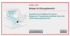
Dieser Fehler signalisiert, dass ein Scanvorgang gestartet wurde, obwohl sich Belege im Einzugsbereich des Scanners befinden. Dies geschieht, wenn nach vorangegangenem Fehler dieser Bereich nicht freigeräumt wurde. Um den Fehler zu beheben, ist vor erneutem Scanstart, gemäß generellem Papierstau-Handling (*Kapitel 9.2.*) zu verfahren. Wird damit der Fehler nicht behoben, kann dies auch auf hängengebliebene Papierschnipsel,
