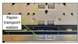
Als Papiertransportwalzen werden die angerauten Metallwalzen bezeichnet, die sich vor und hinter den Scanbereichen befinden. Besonders die oberen ersten drei Walzenpaare, um den Scanbereich der Belegvorderseite, können durch haftende Rückstände von Klebstoff, Gummierung oder Toner im Laufe der Zeit verschmutzen.
