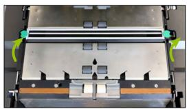
Da sich zu Beginn des Papiertransportweges erfahrungsgemäß die meisten Rückstände ablagern, ist der Bereich unterhalb der Scanebene hiervon am meisten betroffen. Um diese Stelle zu erreichen muss die vordere Andruckeinheit, zwischen Einzug und den Scanbereichen, entfernt werden. Hierfür wird diese Andruckeinheit an den seitlich angebrachten Haltelaschen hinten angehoben und dann komplett aus ihrer Halterung herausgenommen. Da es sich hier um ein Metallteil
