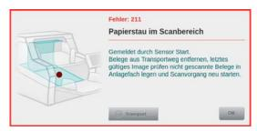
Diese Fehler signalisieren einen Papierstau, der innerhalb der Scanbereiche aufgetreten ist. Um den Fehler zu beheben, ist gemäß generellem Papierstau-Handling (Kapitel 9.2.) zu verfahren. Hierzu kann es nötig sein, das Scanner-Oberteil soweit zu öffnen (Kapitel 6.1.), bis das gestaute Belegmaterial aus der Scanebene entfernt werden kann. Die Fehler 237 und 238 können auch durch einen versehentlich eingeschwenkten weißen Scanhin-
