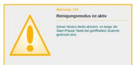
Diese Warnung wird angezeigt, wenn über die Taste **Start/Pause** am Scanner der Modus zum Reinigen der Papiertransportwalzen (*Kapitel 7.3.3.*) gestartet wurde. Nach Beenden des Modus wird die Meldung automatisch geschlossen.
