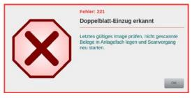
Diese Meldung wird angezeigt, wenn während des Scanvorganges ein Doppelblatteinzug erkannt wurde und die *Reaktion bei Erkennung* (*Kapitel 4.6.4.1.2.*) auf *Fehler* eingestellt ist. In diesem Fall ist über die Imageanzeige oder in der angeschlossenen Scansoftware der letzte richtig gescannte Beleg zu ermitteln. Die nachfolgenden Belege, welche den Doppelblattfehler verursacht haben, sind wieder in das Anlagefach zu legen, bevor der Scanvorgang neu gestartet wird.
