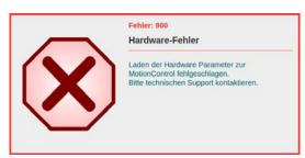
Wird eine Fehlermeldung angezeigt, deren Nummer größer als 900 ist, liegt wahrscheinlich ein Hardwarefehler vor, der durch eigene Maßnahmen oder einen Neustart des Scanners nicht behoben werden kann. Zur Behebung des Fehlers ist hier auf jeden Fall der zuständige Servicetechniker oder der technische Support der *InoTec* (*Kapitel 10.3.*) zu benachrichtigen.
