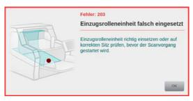
Dieser Fehler wird angezeigt, wenn am Gerät während des Scanvorganges die Einzugsrolleneinheit aus Ihrer Halterung gesprungen ist oder versucht wurde einen Scanvorgang zu starten, obwohl die Einzugsrolleneinheit nicht richtig eingesetzt ist. Um den Fehler zu beheben, muss geprüft werden, ob die Einzugsrolleneinheit richtig in ihrer Halterung sitzt (*Kapitel 7.2.1.*). Vor erneutem Scanstart müssen alle Belege entfernt werden, die
