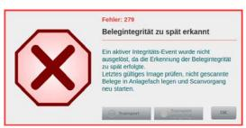
Dieser Fehler wird angezeigt, wenn im verwendeten Scanprofil die *Belegintegritäts-Erkennung* aktiviert (*Kapitel 4.6.4.7.*) wurde, das Ergebnis der Erkennung aber zu spät erfolgte, um ein dafür aktives Ereignis (*bspw. Beleg nach hinten auswerfen*) noch auszuführen. Um den Fehler zu beheben, ist gemäß generellem Papierstau-Handling (*Kapitel 9.2.*) zu verfahren, bevor der Scanvorgang erneut gestartet wird.
