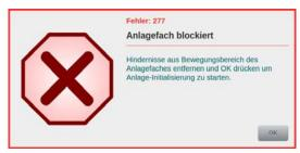
Dieser Fehler wird angezeigt, wenn das ordnungsgemäße Anheben oder Absenken des Anlagefaches gestört wurde. Um den Fehler zu beheben, müssen Störfaktoren aus dem Bewegungsbereich des Anlagefaches entfernt werden. Danach wird durch Drücken der Taste **OK** eine Initialisierung des Anlagefaches durchgeführt.
