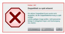
Diese Meldung wird angezeigt, wenn die Erkennung eines Doppelblattes als Ereignis zur Steuerung einer weiteren Funktion dienen soll (*Kapitel 4.2.3.*), das Doppelblatt auf dem aktuellen Beleg aber dafür zu spät erkannt wurde. Zum Beheben des Fehlers ist vor erneutem Scanstart gemäß generellem Papierstau-Handling (*Kapitel 9.2.*) zu verfahren und der betroffene Beleg, der als Doppelblatt erkannt wurde, zu prüfen.
