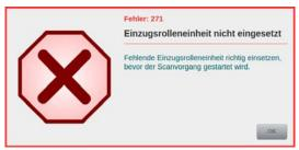
Dieser Fehler wird angezeigt, wenn versucht wurde einen Scanvorgang zu starten, obwohl die Einzugsrolleneinheit nicht erkannt wurde. Um den Fehler zu beheben, muss die Einzugsrolleneinheit ordnungsgemäß in ihre Halterung eingesetzt werden (*Kapitel 7.2.1.*).
