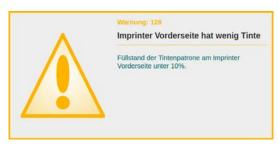
Diese Warnung wird initial im Statusbereich angezeigt, sobald der Füllstand der Tintenpatrone die Restmenge von 10% unterschreitet. Da sich der Füllstand der Tintenpatronen für die Imprinter lediglich aus den Herstellerangaben des Inhaltes abzüglich verbrauchter Tintenmenge berechnet (*Kapitel 8.3.2.*), sollte ab Auftreten der Warnung der Imprinterdruck geprüft und bei Bedarf eine neue Patrone eingesetzt werden.
