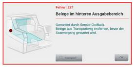
Dieser Fehler signalisiert, dass ein Scanvorgang gestartet wurde, obwohl sich Belege im Bereich der hinteren Belegausgabe befinden. Dies geschieht, wenn nach vorangegangenem Fehler dieser Bereich nicht freigeräumt wurde. Um den Fehler zu beheben, ist vor erneutem Scanstart, gemäß generellem Papierstau-Handling (Kapitel 9.2.) zu verfahren. Wird damit der Fehler nicht behoben, kann dies auch auf hängengebliebene Papier-
