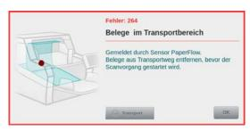
Dieser Fehler signalisiert, dass ein Scanvorgang gestartet wurde, obwohl sich Belege im Transportbereich des Scanners befinden. Damit wird der Bereich zwischen Scanebene und Belegausgabe bezeichnet. Dies geschieht, wenn nach vorangegangenem Fehler dieser Bereich nicht freigeräumt wurde. Um den Fehler zu beheben, ist vor erneutem Scanstart, gemäß generellem Papierstau-Handling (*Kapitel 9.2.*) zu verfahren. Wird da-
