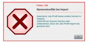
Sollen Scan-Jobs/-Profils importiert werden (*Kapitel* 4.7.6.2.), die namentlich auf dem Scanner bereits vorhanden sind, tritt dieser Fehler auf. Um den Fehler zu umgehen, müssen die Scan-Jobs/-Profile mit identischem Namen auf dem Scanner zuvor gelöscht oder umbenannt (*Kapitel* 4.5./ 4.6.) werden.
