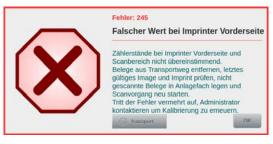
Dieser Fehler tritt nur auf, wenn der Imprinter Vorderseite aktiv ist und, aufgrund eines Erkennungsfehlers, einer der Zählerstände für diesen Beleg nach der Druckposition dieses Imprinters noch verändert wird. Beim auslösenden Beleg ist der Aufdruck zu prüfen. Ein eventueller Patchcode ist auf Qualitätsmängel zu prüfen und notfalls auszutauschen. Vor erneutem Scanstart ist gemäß generellem Papierstau-Handling (*Kapitel 9.2.*)
