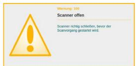
Diese Warnung wird bei Auftreten zunächst nur im Statusbereich angezeigt und bedeutet, dass die Scanebene des Scanners nicht richtig geschlossen ist. Um die Warnung zu beseitigen, muss die Scanebene ordnungsgemäß geschlossen werden (*Kapitel 6.1.*). Wird in diesem Status versucht, einen Scanvorgang zu starten, erhält man eine ähnlich lautende Fehlermeldung (*Kapitel 9.2.1.*).
