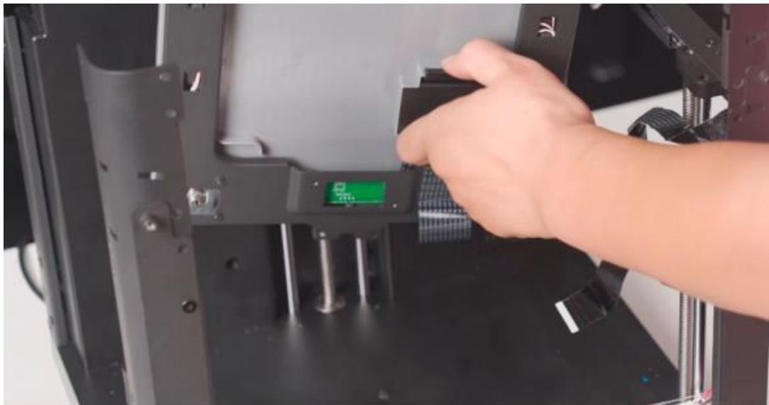
**Schritt 3:** Trenne das Kabel und stecke es erneut ein.
