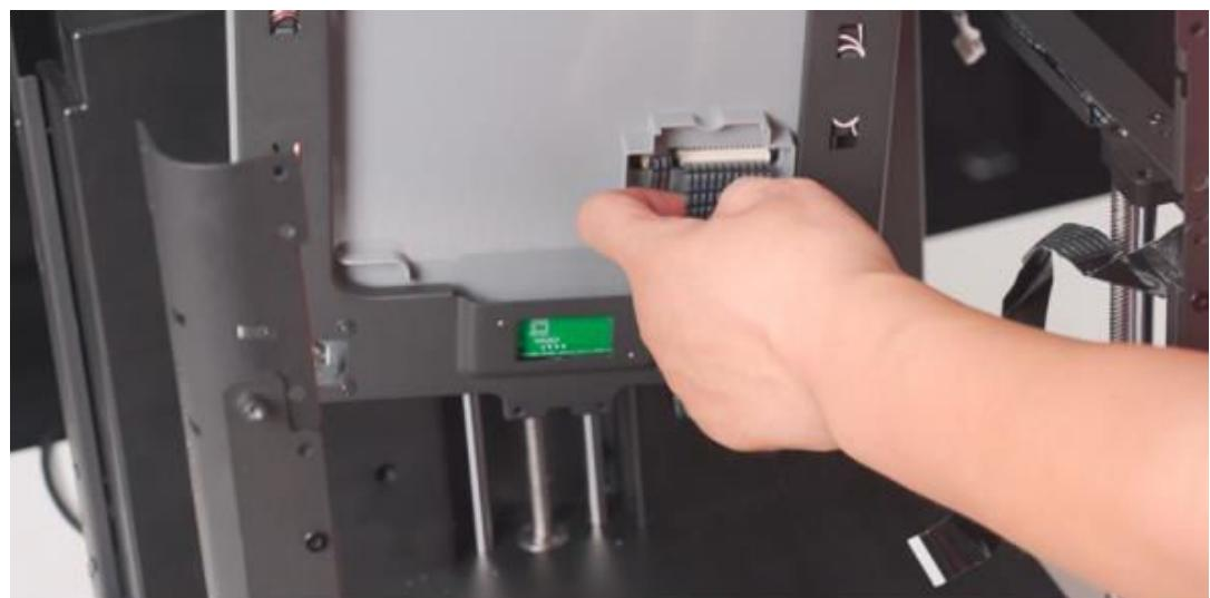
**Schritt 4:** Trenne und stecke das Motherboard-Kabel erneut ein (entferne dazu alle Schrauben auf der Rückseite des Druckers).
