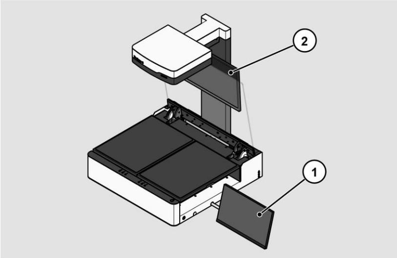
Der Scanner wird mit zwei separat verpackten Monitoren ausgeliefert.
