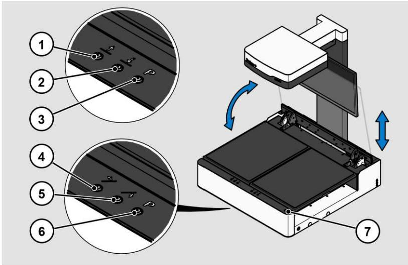
Das Bedienpult des Bookeye® 5 V1A verfügt über sieben Tasten mit zusätzlichen Funktionen zur Glasplattensteuerung.
