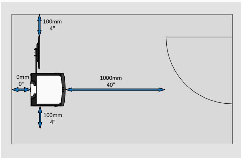
Stellen Sie den Scanner auf einen ebenen und tragfähigen Unterbau (mindestens vier Tischbeine). Die Tragfähigkeit des Unterbaus muss für das Gewicht des Scanners (mindestens 120 kg.) geeignet sein. Die Maße des Unterbaus müssen für die Stellfläche des Scanners passend dimensioniert sein (mindestens 90 cm x 180 cm).
