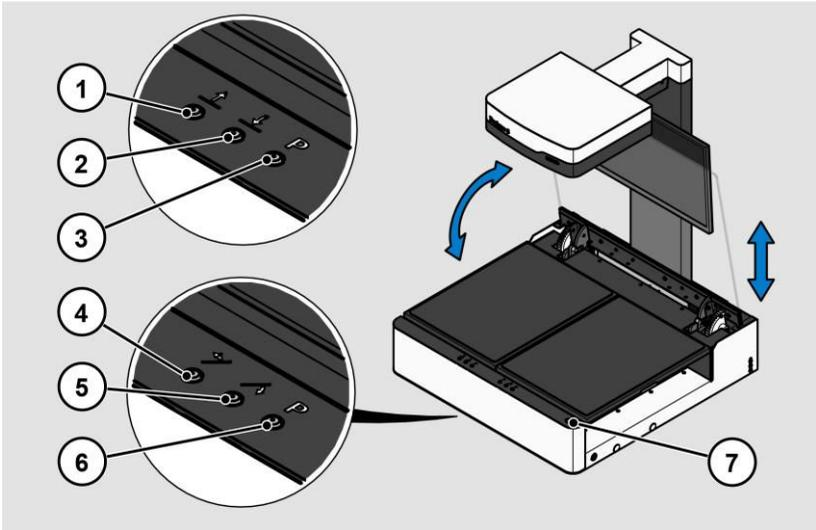
Mit den Bedienpulttasten des Bookeye® 5 V1A kann das Fahren der Glasplatte während eines Scanprozesses zusätzlich gesteuert, programmiert oder unterbrochen werden.
