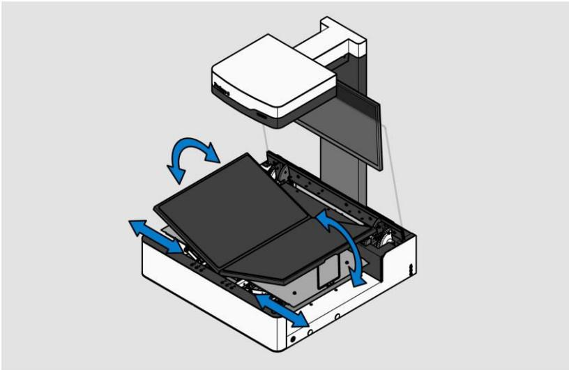
Die V-Stellung wird für sehr empfindliche, alte Bücher und Dokumente empfohlen. Der Öffnungswinkel zwischen den Buchwippenplatten beträgt 140 Grad. Wenn die Buchwippen in die V-Stellung angehoben werden, werden sie auf jeder Seite von einem Stützbein gehalten. In der "V"-Position können die Platten auch horizontal auseinandergeschoben werden. Der geringe Öffnungswinkel strapaziert die Buchbindung nur minimal.
