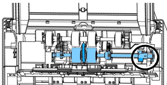
4. Lösen Sie das rechte Ende der ADF Rolle aus dem Schlitz und entfernen Sie die obere ADF-Rolle.
