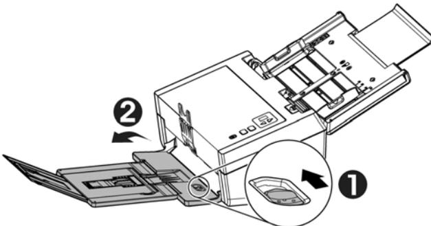
3. Legen Sie den Stapel dünnes Papier in die Papierablage ein. Richten Sie die Papierführungen aus und stellen Sie sicher, dass die Papierkanten die Papierführungen an beiden Seiten wie abgebildet leicht berühren.
