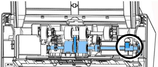
Schließen Sie die ADF Rollenabdeckung. Bei korrekter Installation erklingt ein Einschnapp-Geräusch.
