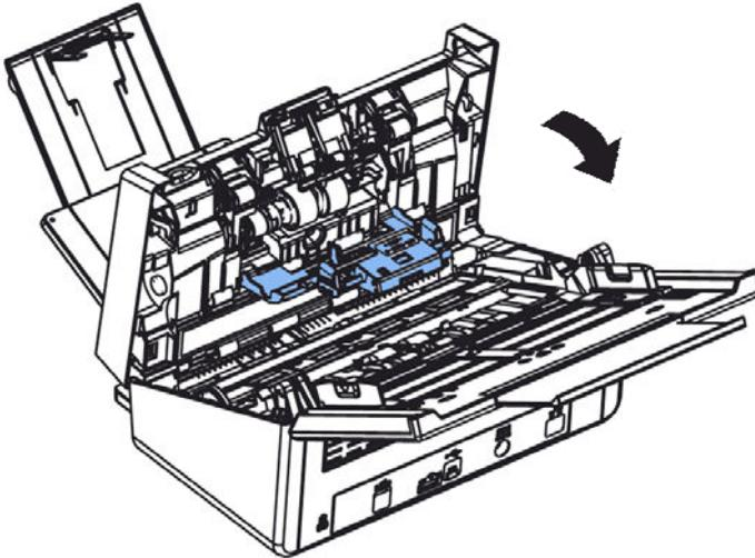
1. Drücken Sie das rechte Ende der Umkehrwalze zum Entfernen aus dem Schlitz nach außen, lösen Sie dann das linke Ende aus seiner Öffnung.
