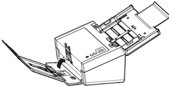
2. Schieben Sie den Positionseinsteller des Ausgabefachs so, dass sich das Ausgabefach in einer flachen Position befindet.
