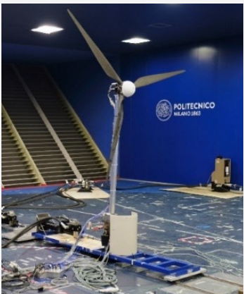
Politecnico di Milano wind tunnel during the UNAFLOW project with scaled DTU-10MW RWT (image credit: Alessandro Fontanella, Politecnico di Milano)
