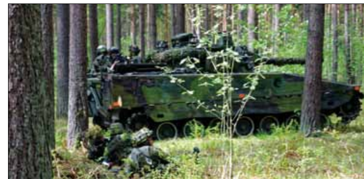
Stridsfordon 9040C, vikt 23 ton, en Bofors 40 mm L/70 och en 7,62 mm kulspruta m/58C. Vagnchef, skytt, förare och sju soldater får plats i stridsfordonet. Fart 70 km/tim.
