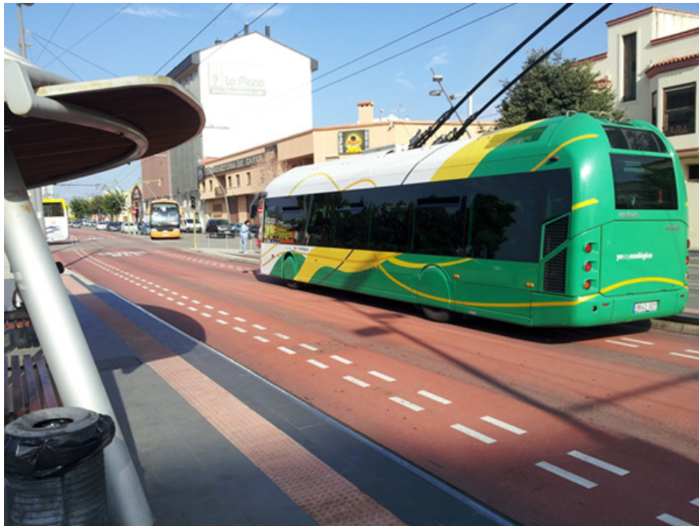
[Een voertuig van Irisbus op de dedicated lane met bovenleiding. Beeld: Creative Commons]
