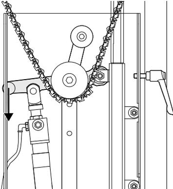
5. Verschieben Sie den Spanner nach unten, bis die Sägekette fest sitzt ist. Es sollte ein Spalt von 10 bis 15 mm zwischen der Mutter des Pneumatikkolbens und dem Pneumatikkolben vorhanden sein. Innerhalb dieses Spalts sollte der Kolben sichtbar sein.
