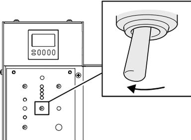
3. Schalten Sie den Schalter für den Kettenschieber ON (ein) (A). Wenn der Kettenschieber die Kette vorwärts befördert, befindet sich die Sägeketten-Klemmvorrichtung in der Position ENTRIEGELT (C). Schalten Sie den Schalter für den Kettenschieber OFF (aus) (D).
