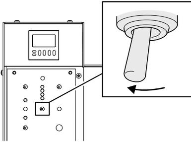
2. Verwenden Sie den Sechskantschlüssel (im Lieferumfang der Maschine enthalten), um die Schraube für die Zahndachwinkleinstellung drei Umdrehungen zu lösen.
