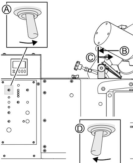
4. Stellen Sie sicher, dass die Nut in der Sägeketten-Klemmvorrichtung etwa 2,2 mm beträgt. Verwenden Sie dazu eine Fühlerlehre. Falls erforderlich, passen Sie die Einstellung der Sägeketten-Klemmvorrichtung mit den Muttern an, sodass die Fühlerlehre herausrutschen kann.
