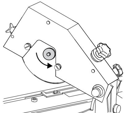
4. Befestigen Sie die geeignete Scheibe auf der Nabe. Ziehen Sie die Scheibe mit mäßigem Druck handfest an und sichern Sie die die Scheibe mit der Scheibenbefestigungsmutter.
