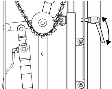
2. Wenn Sie die obere Spannrolle verwenden, führen Sie die Sägekette unter die Spannrolle.
