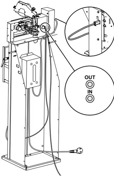
**⚠ WARNUNG** Befestigen Sie Luftschläuche und Kabel mit Kabelklemmen, um Stolpergefahren auszuschließen.
