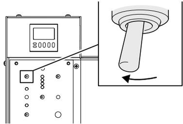
14. Heben Sie den Spannerarm an (Schnellentriegelungsfunktion) und entnehmen Sie die Sägekette.
