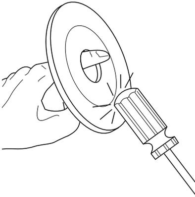
Wenn Sie die Schleifscheibe geprüft haben und diese unbeschädigt ist, können Sie mit der Montage beginnen.
