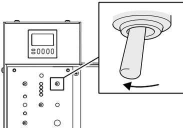
13. Schalten Sie den Schalter für den Kettenschieber OFF (aus).
