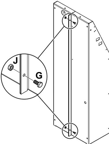
3. Zum Schluss verschrauben Sie die Seitenverkleidung zuerst mit der Grundplatte und dann mit dem Vorderteil.
