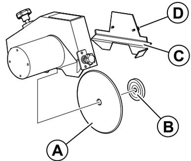
3. Entfernen Sie die Scheibenbefestigungsmutter von der Nabe.
