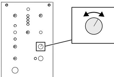
**HINWEIS** Wenn sich das Metall an den Schneidgliedern beim Schärfen blau verfärbt, ist die Drehzahl zu hoch eingestellt und das Metall wird überhitzt. Dies kann dazu führen, dass das Metall des Schneidglieds seine Eigenschaften verliert. Ersetzen Sie beschädigte Schneidglieder oder schärfen Sie die Sägekette neu.
