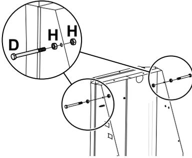
8. Der Standfuß muss an den Bohrungen in der Grundplatte des Standfußes mit dem Boden verschraubt werden.
