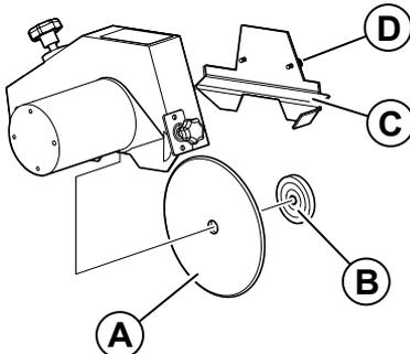
5. Entnehmen Sie die Schleifscheibe (A) von der Schleifscheibenachse und entsorgen Sie sie gemäß der lokalen, regionalen und nationalen Gesetze und Bestimmungen.
