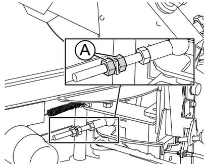
7. Wiederholen Sie die Schritte 2 bis 5, bis die Zahndachwinkel in beiden Richtungen gleich sind.
