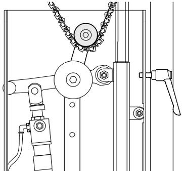
3. Wenn Sie die untere Spannrolle verwenden, heben Sie den Spannerarm an (dafür gibt es eine Schnellentriegelungsfunktion) und führen Sie die Sägekette unter die Spannrolle.
