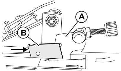
2. Schärfen Sie die Sägekette, wie in Kapitel 5.3, „Bedienung der Maschine“ beschrieben.
