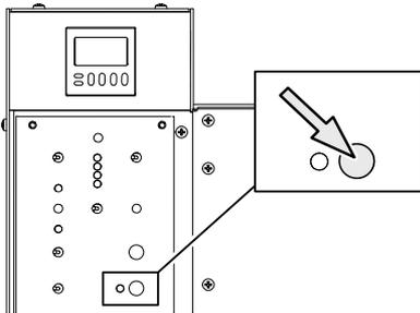
2. Schalten Sie den Schalter für den Sensor ON (ein).
