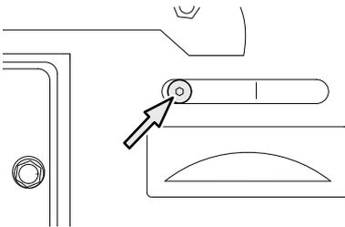
3. Drehen Sie den Schärfkopf, um den gewünschten Zahndachwinkel (0 bis 35°) mit der Zahndachwinkel-Skala einzustellen. Der Standard-Zahndachwinkel beträgt 30°.
