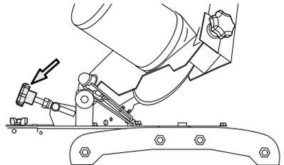
5. Schalten Sie den Kettenschieber OFF (aus), wenn sich der Schärfkopf in seiner höchsten Position befindet und die Kettenverrieglung nicht aktiviert ist.
