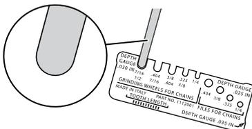
8. Wiederholen Sie die Schritte 4 bis 8, bis das Schleifscheibenprofil mit dem entsprechenden Profil der Profilschablone übereinstimmt.
