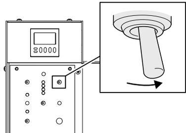
5. Schalten Sie den Schalter des Kettenschiebers ON (ein), um den Vorschub der Sägekette und die Bewegung des Schärfkopfs zu starten. Der Schärfvorgang wird gestartet.
