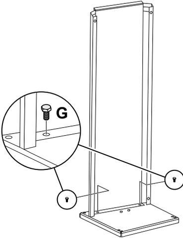
2. Verschrauben Sie anschließend die beiden Seitenteile miteinander, indem Sie die mitgelieferten Schrauben durch die Bohrungen an den Stoßkanten der zwei Teile stecken und festziehen.
