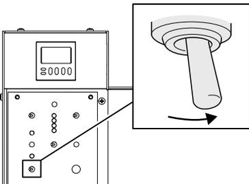
4. Schalten Sie den Schleifscheibenschalter ON (ein), um den Schleifmotor zu starten.
