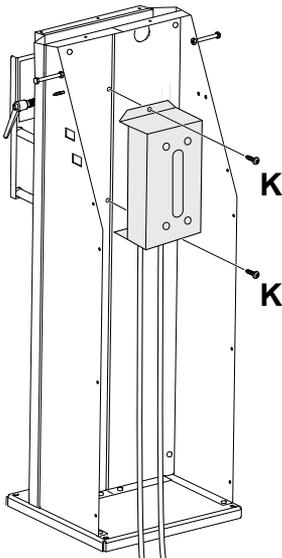
10. Setzen Sie danach die Maschine auf den Standfuß. Befestigen Sie die Maschine mit den mitgelieferten Schrauben und Muttern an den drei Bohrungen auf der Rückseite der Maschine am Standfuß.
