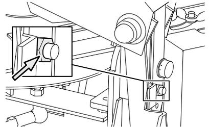
2. Drehen Sie den Schärfkopf, um den gewünschten Neigungswinkel für den Schärfkopf (50 bis 70°) mit der Neigungswinkelskala einzustellen. Der Standardwinkel für die Schärfkopfneigung beträgt 60°.
