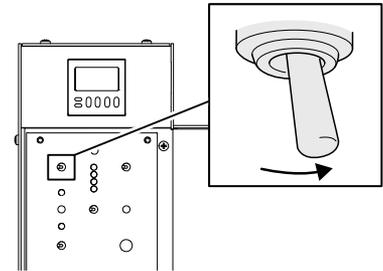
6. Drücken Sie die Rückstelltaste, wenn der Schärfkopf zum ersten Mal nach unten bewegt wird. Damit wird der Zähler zurückgesetzt.
