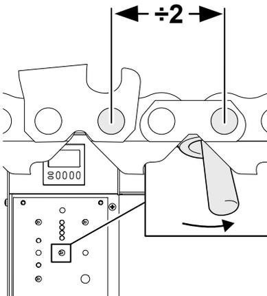
5. Lösen Sie die Flügelmutter für die Kettenteilung und verschieben Sie die Sägekette in die korrekte Position. Ziehen Sie die Flügelmutter wieder fest.
