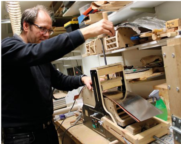
► För att kunna forma gitarrens sarg behöver träet hettas upp till 150 grader. Maskinen har Bengt Wälivaara tillverkat själv.
