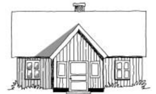
Framhäv entrén genom att dra ut den arkitektoniskt en bit från huskroppen.
