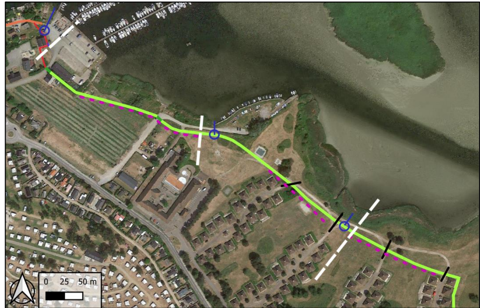
Figur 5.6: Anbefalet linjeføring af højvandsbeskyttelse mellem lystbådehavnen og Fjordhusene 104. Detaljer omkring grøftens eksakte placering og form udarbejdes i detailfasen.
