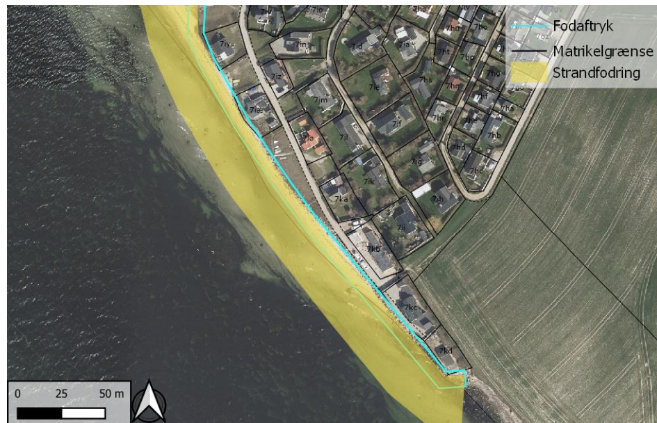
Figur 5.35: Resulterende fodaftryk af den anbefalede højvandsbeskyttelse og skråningsbeskyttelse mellem Strandvej 24 og 31. Oven på skråningsbeskyttelsen lægges strandfodring op til kote +1,3 m over det normale daglige vande
