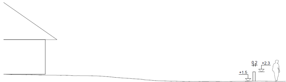
Figur 5.8: Principskitse af højvandsmuren ved Lysbådehavnen. Vandkanten er beliggende til højre for det viste profil. Personen på skitsen går på pladsen foran havnekontoret.
