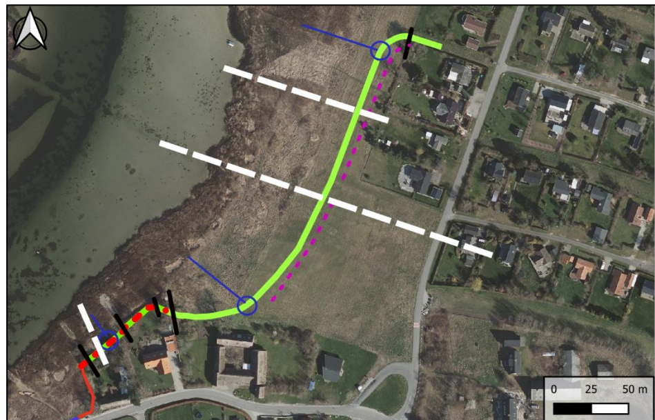
Figur 5.18: Anbefalet linjeføring af højvandsbeskyttelse mellem Enø Kystvej 119 og Reedtzholmvej 180. Detaljer omkring grøftens eksakte placering og form udarbejdes i detailfasen.
