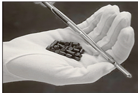
Figur 13.2: Brenselsbriketter ( fuel pellets ) og briketter montert i en brenselspinne. (Vinduet i kapslingen viser brenselsbrikettene på innsiden)
