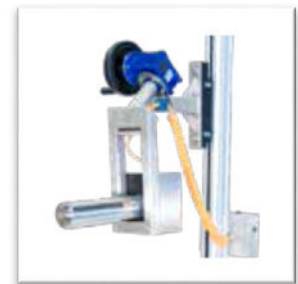
Expand & Turn- Pneumatisk expander med manuell vrid
