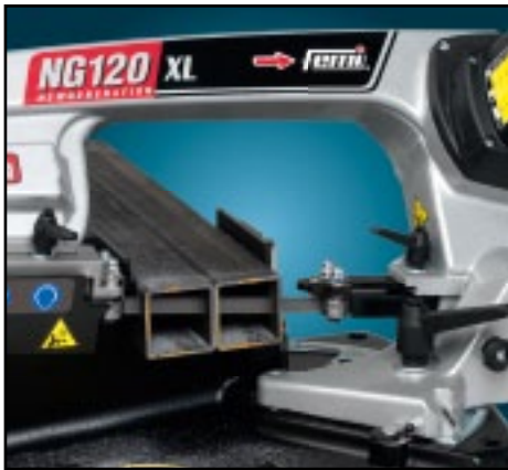
Maximum cutting capacity 120 x 102 mm. Capacidad de corte máxima 120 x 102 mm.
