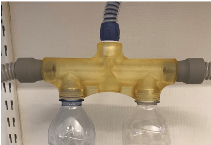
Fig 3. Bild på kopplad T-koppling
