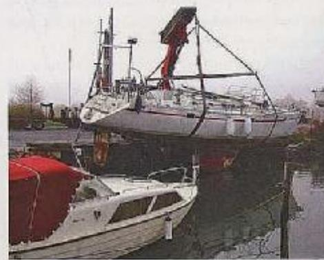
Fejlplacerede stropper er en af de hyppigste årsager til skader i forbindelse med kraførs løft. Kilde: Pantaenius.
