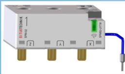
Der intelligente Energiesensor SPM-02 ist ein Überwachungsgerät, das in einem Stromverteiler installiert werden kann, ohne Platz auf der DIN-Schiene zu beanspruchen. Er kann elektrische Kennzahlen in Echtzeit überwachen, Alarmmeldungen senden und zusammen mit anderen intelligenten Geräten eine Automatisierung erstellen.
