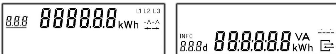
Die Software-Versionsnummer des metrologischen Teils wird mit der dazugehörigen Prüfsumme am Display angezeigt. Die Software-Version wird mit dem Index 1 angegeben.
