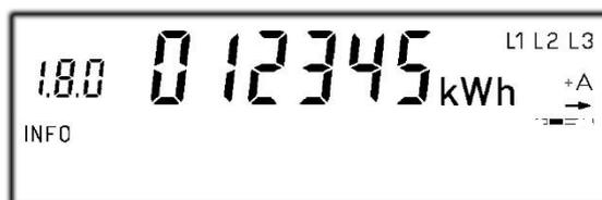
Variante Doppeltarif der Stromrichtung +A: abwechselnde Anzeige zwischen Register 1.8.1 und 1.8.2
