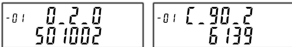
Die Software-Versionsnummer des internen Kommunikationsadapters wird mit der dazugehörigen Prüfsumme am Display angezeigt. Die Software-Version wird mit dem Index 2 angegeben.
