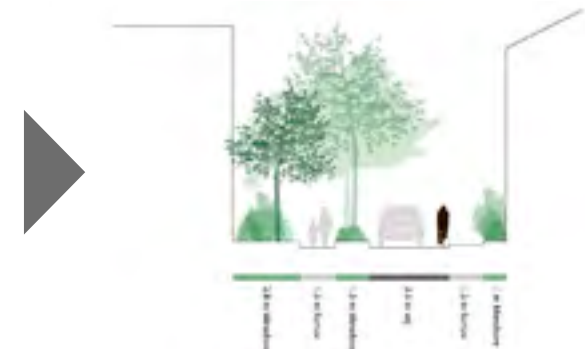
PRINCIPSNIT BB gennem Norgesgade. Viser en mulig fordeling af både trafik- og byrumsfunktioner.
