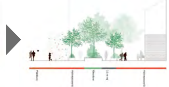
PRINCIPSNIT AA gennem Norgesgade. Viser en mulig fordeling af både trafik- og byrumsfunktioner.
