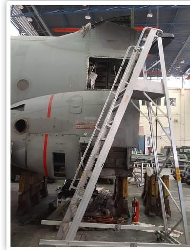
Tout d'abord, nous devons rendre le fuselage du C-130H CH03 étanche aux intempéries et également accessible. Les charnières de la « crew entrance door » sont manquantes et doivent être achetées ou fabriquées. La partie restante de la soute (6 m de long) doit être fermée et rendue étanche. A cet effet, nous allons installer une structure de porte en aluminium/verre, que nous avons obtenu gratuitement, sur toute la largeur de la soute, au niveau avant des « main wheel wells ».
