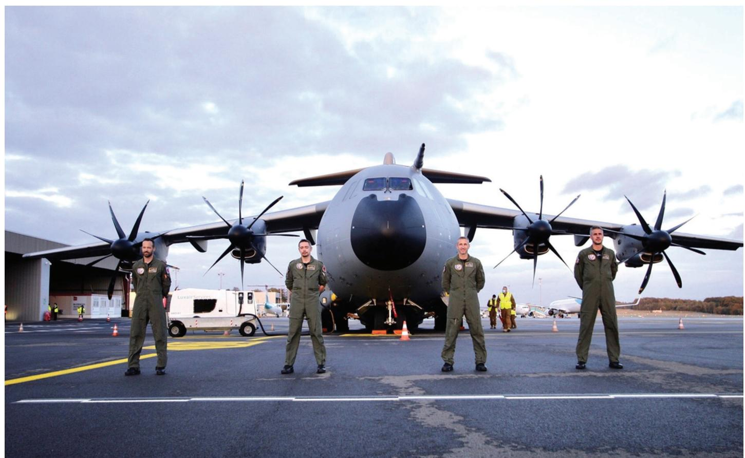
de druk in de cabine te aanvaarden. De maximale operationele vliegsnelheid (Vmo/Mmo) bedraagt 300 kt/0.72 M of 540 km/u en 72% van de lokale geluidssnelheid.
