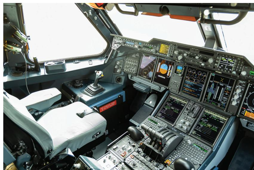
en cursorcontrole-eenheden. Het displaysysteem en de bedieningspanelen vormen de gebruiksvriendelijke interface voor de bemanning naar het Flight Management System, de Mission Systems en voor het onderhoudspersoneel naar de digitale onderhoudssystemen. Ze bieden een snelle, intuïtieve toegang tot alle
