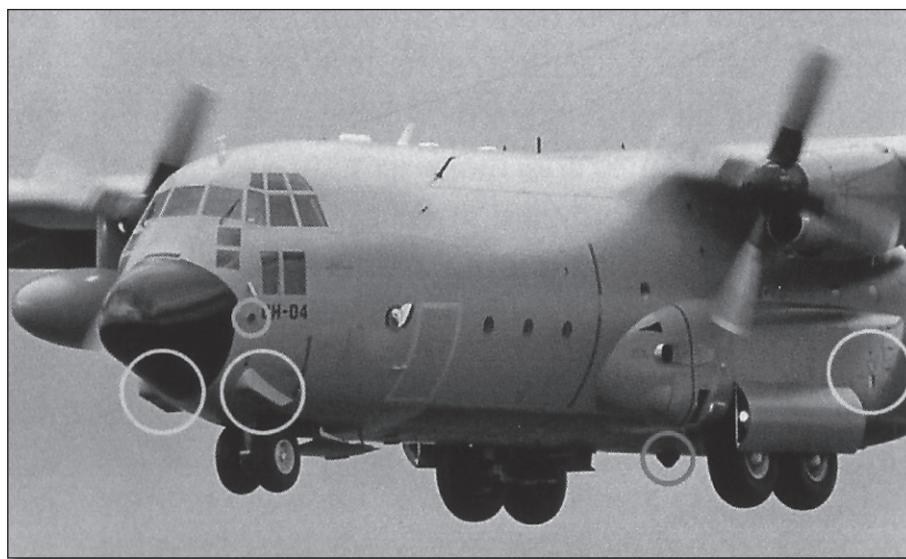
feu du chaff et/ou flares du système modernisé AN/ALE-40 ACMDS à droite et à gauche sous le nez et derrière dans les coiffes de carénage du train d'atterrissage principal (voir photo). Le système AN/ALE-40 fut développé à
