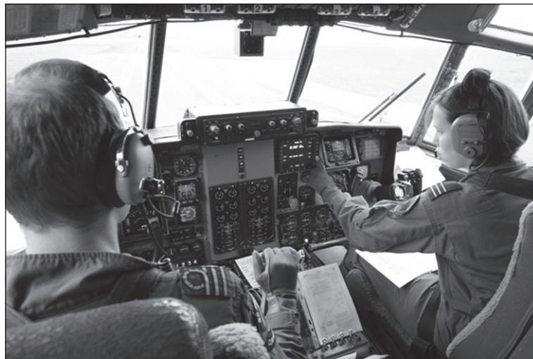
Afin d'intégrer ces trois systèmes et de leur permettre d'échanger des informations, Terma incorpore son système AN/ALQ-213(V) EWMS (Electronic Warfare Management System) dans les Hercules et en fournit le logiciel approprié.
