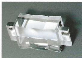
Der AF-Kondensator bereitet die Motivinformation für den CCD-Sensor zielgerichtet und kontrastreich auf.
