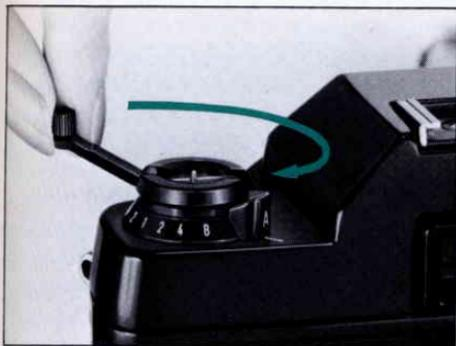
Vor dem Öffnen der Camera muß der Film in die Filmkassette zurückgespult werden.
