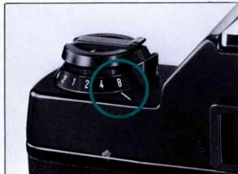
Die "B"-Einstellung dient für extreme Langzeitbelichtungen und wird gleichzeitig durch den Belichtungszeitenindex im Sucher angezeigt.
