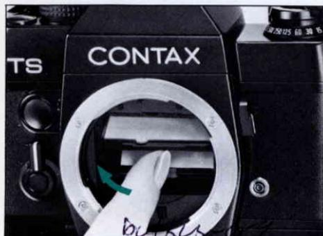
Lesen Sie vor dem Auswechseln der Einstellscheibe die ihr beigefügte Gebrauchsanweisung durch. Es ist darauf zu achten, daß diese und der Spiegel nicht direkt mit den Fingerspitzen berührt werden. Verwenden Sie eine Pinzette.
