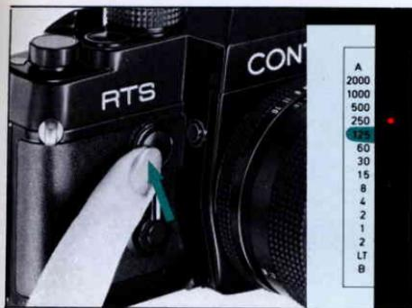
Bei Automatic-Betrieb wird die Belichtungszeit automatisch zur vorgewählten Blende und den jeweiligen Lichtverhältnissen eingestellt; zur präzisen Belichtung werden durch die Automatic auch Zwischenwerte eingestellt. Bei manueller Handhabung können ausschließlich die eingravierten Belichtungszeiten benutzt werden.
