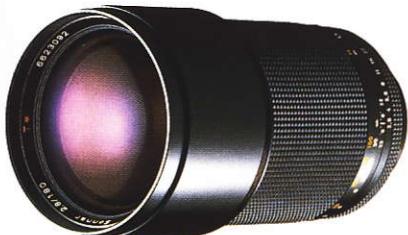
Die aktuelle modifizierte Version des berühmten „Olympia-Sonnar“. Die große relative Öffnung von f2,8, kombiniert mit der langen Brennweite von 180 mm macht dieses Objektiv zum Spezialisten für Action/Sport-Fotografie.
