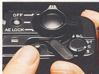
Der Entriegelungsknopf zur Filmrückspulung. Um eine unbeabsichtigte Betätigung zu vermeiden, befindet sich der Entriegelungsknopf unter einer schwenkbaren Abdeckkappe.
