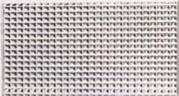
Die Streuscheibe wird vor dem Blitzreflektor befestigt und erweitert den Leuchtwinkel von 60° horizontal und 48° vertikal auf 76° bzw. 58°. Damit ist der Leuchtwinkel auch für 24-mm-Brennweiten geeignet.
