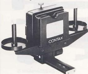
Der Diakopiervorsatz wird an der Balgen-Objektivstandarte befestigt und ermöglicht das Kopieren von einzelnen, gerahmten Dias oder Filmstreifen. Eine Opal-Scheibe sorgt für die gleichmäßige Ausleuchtung der Vorlage.
