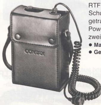
Stromquelle für den mobilen RTF 540-Einsatz. Nimmt 12 Mignonbatterien 1,5 V oder 2 NC-Akku-Sätze auf. Blitzzahl mit Batterie (bei voller Leistung) 100, NC-Akkus 50. In Automatik-Betrieb ca. 300 bzw. 150. Das RTF-Power Pack kann entweder mittels Schulterriemen oder am Gürtel befestigt getragen werden. Lieferumfang: RTF-Power Pack, Tasche, Trageriemen und zwei RTW-Batteriemagazine.
