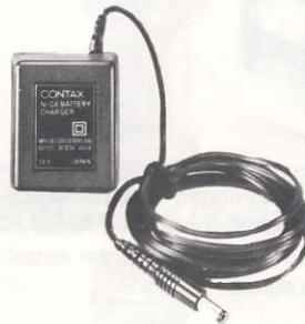
Wird gemeinsam mit dem RTW-Ladeadapter zum Aufladen der RTW-NC-Akkus verwendet. Die Ladedauer beträgt ca. 10 Stunden. Ist in drei Primärspannungstypen erhältlich: 100, 120 und 220 V. Sekundärstrom: 8,7 V, 45 mA.
