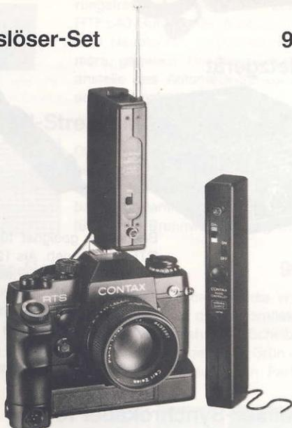
Mit einer Reichweite von maximal 300 m ist dieser Fernauslöser unerlässlich in der Tier- und Überwachungsfotografie. Die Auslösung kann zweikanalig erfolgen und zwei Camera-Einheiten voneinander unabhängig steuern. Der Empfänger ist mit einer Teleskopantenne ausgestattet und wird — am Camera-Blitzschuh befestigt — mittels Kabel mit der Camera/Winder/Motor-Auslösebuchse verbunden. Einzel- und Serien-Auslösungen sind möglich.
