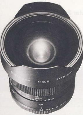
Super-Weitwinkel hoher Lichtstärke, ideal für besondere perspektivische Effekte und umfassende Innenaufnahmen. Bereits geringe Abblendung ergibt eine exzellente Bildfeldausleuchtung. Durch ein „floating element“ auch im Nahbereich hohe Abbildungsqualität.
