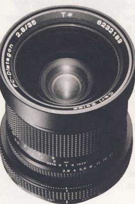
Ein Spezialobjektiv mit besonders großem Bildkreisdurchmesser von 63 mm, entsprechend der für die Perspektivkorrektur notwendigen Objektivverschiebung von 10 mm ab optische Achse. Das Objektiv ist selbstverständlich drehbar gelagert, die Korrektur kann in jeder beliebigen Richtung erfolgen Nahbereichskorrigiert.
