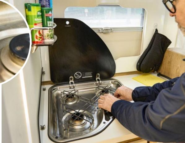
Oft fehlen Gummistopfen für Gitterroste. Sie erfordern keine große Investition, und schon hat das Klappern am Herd ein Ende.
