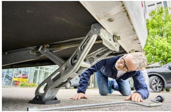
Die Funktionsprüfung der Kurbelstützen gehört ebenfalls zum Pflichtprogramm für Wohnwagen beim Camper-Check.
