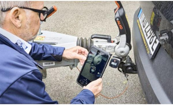
Bei Caravans kommt es auf die Stützlast an. Ein spezielles Messgerät ermittelt den Wert, per Foto wird dokumentiert.
