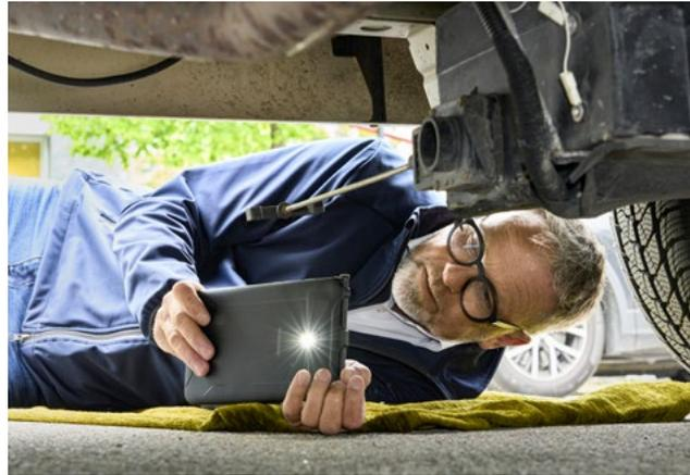
Der Zustand des Unterbodens und des Fahrwerks wird per Tablet abgespeichert, die Multitalente dienen auch als Leuchte und Kamera.
