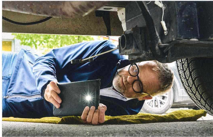
Der Zustand des Unterbodens und des Fahrwerks werden per Tablet abgespeichert, die Multitalente dienen auch als Leuchte und Fotoapparat.
