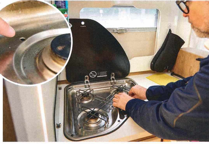
Fehlen oft: Haltestopfen für Gitterroste kosten rund zwei Euro. Keine Großinvestition, und schon hat das Klappern während der Fahrt ein Ende.
