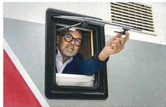
Aufsteller in Ordnung, Dichtung okay? Kratzer? All das ist wichtig!
