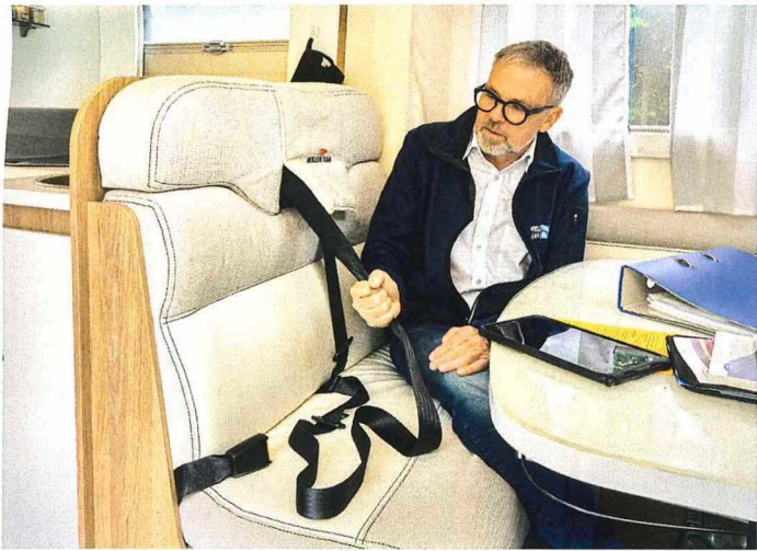
Sicherheitsrelevante Bauteile wie die Gurte der Sitzbank werden besonders kritisch in Augenschein genommen, Defekte per Foto dokumentiert.
