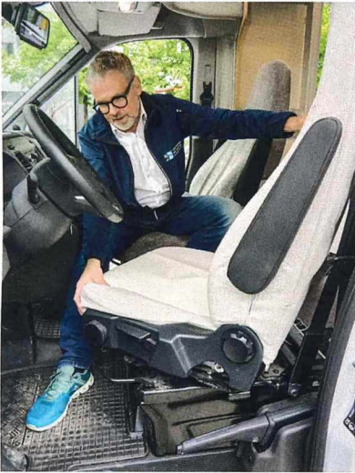
Drehsitzkonsolen müssen leichtgängig sein und sicher einrasten.
