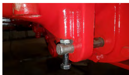
Sprinten till dragarmen provmonterad i bakaxelröret. Dragarmen saknas.
