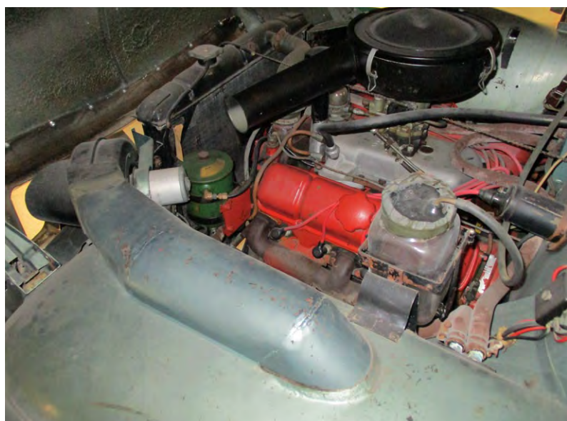
Här syns V8-motorn. Röret på innerskärmen går till kupéventi- lationen.
