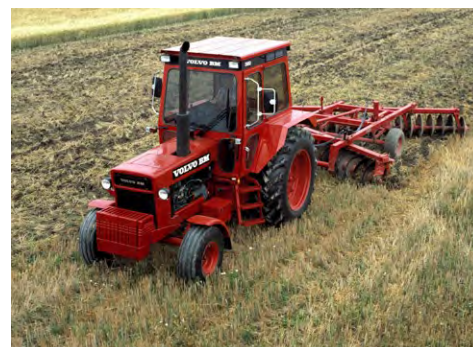
Volvo BM 2650. Den största traktorn i nya serien. 6-cylindrig turbodiesel på 130 kW.
