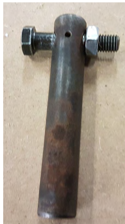
Här syns sprinten till dragarmen med M12 skruven monterad.
