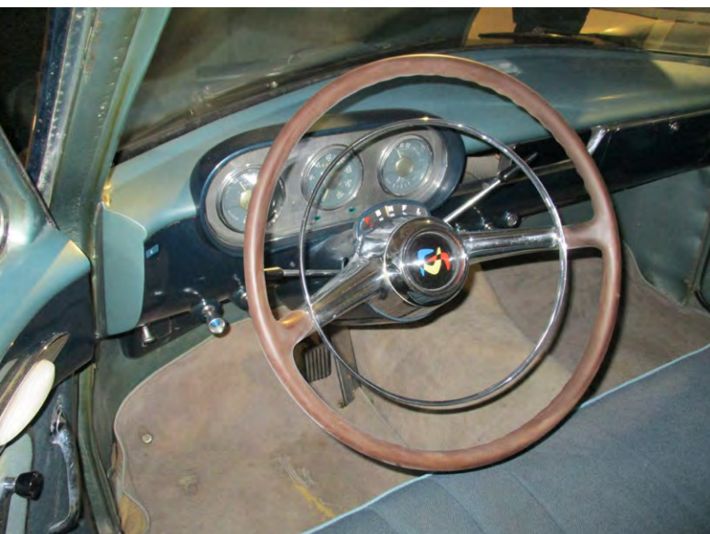
Sparsmakad instrumentering. Växelväljaren sitter på rattstäng- en. Observera att Bumerangmönstret går igen i rattcentrumet.
