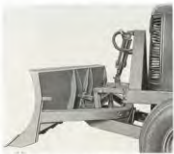
Schaktbladets höj- och sänkning utförskemas med hjälp av en hydraulisk pump. Denna är skapad för att kunna hantera stora mängder av vätska under tryck. Schaktbladet kan med hydraulisk hjälp pressas mot marken och kan arbeta under tryck utan att gå in till en djup av ca 15 cm. Genom ett centralsystem är avsaknad lagrad kan bladet sänkas i horisontellt läge med ca 2° åt vardera sidan. Diagonallastning sker med ett enkelt handgrepp och utan några verktyg.
