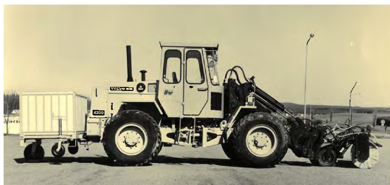
Redskap och maskiner för väg- och gatuhållning, BM:s hjullastare och traktorgrävare, 1957–1985: diagonalblad med mekanisk eller hydraulisk vinkelinställning, diagonalblad typ kommunal med hydraulisk vinkelinställning, schaktblad, spetsplog för snöröjning, sopvals SBH mekaniskt eller hydrauliskt driven, sopmaskin Master 600 och sandspridare.
