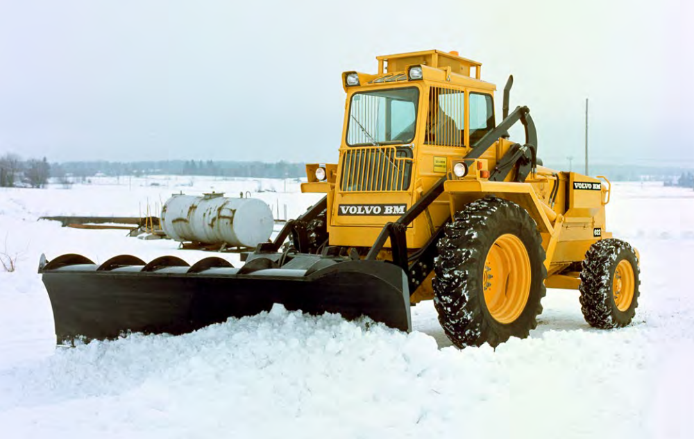
Volvo BM LM 622 med nya, större redskapsfästet.
