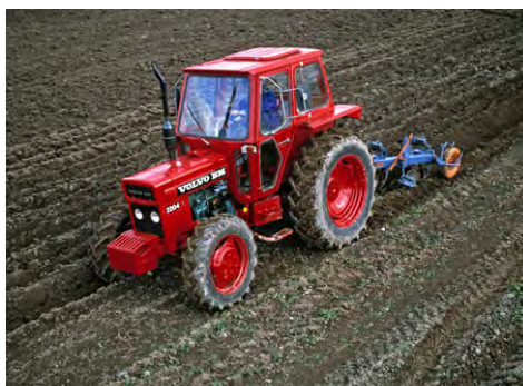
Här syns Volvo BM 2254. Minstingen i den nya serien. Näst sista siffran säger att den är utrustad med en fyrcylindrig motor på 41 kW och sista siffran säger att den är fyrhjuldriven.
