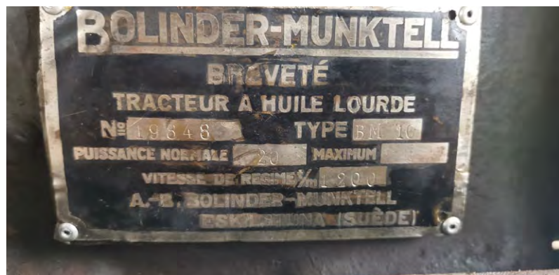
Typskylten på motorn som är på franska. Det ser ut som den varit demonterad.
