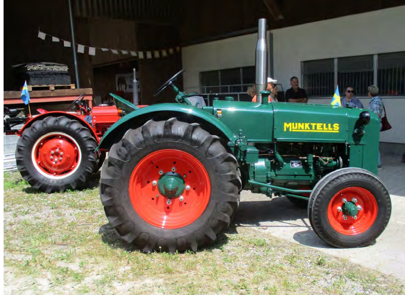
Ljuddämparen är nytillverkad i rostfri plåt. Observera hjulmuttrarna som rengjorts och elförzinkats. Bakom BM-20 står Patricks T 24.
