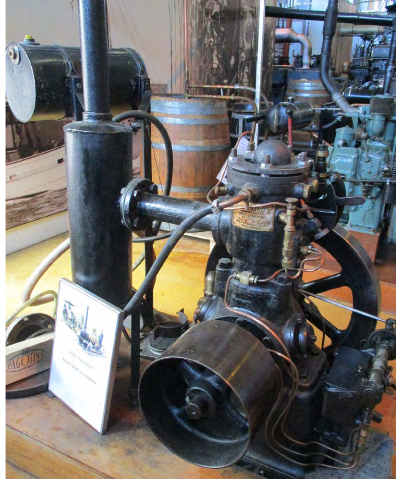
En av de första tändkulemotorerna enligt Rundlöfs patent. Motorn står idag på Munktellemuseet. Här syns tändkulan tydligt.
