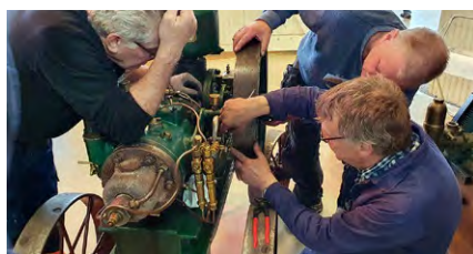
Det är många delar i bränslesystemet och här gäller det att vara noggrann. Motorn på bilden är en Munktells Ideal på 5 hk.
