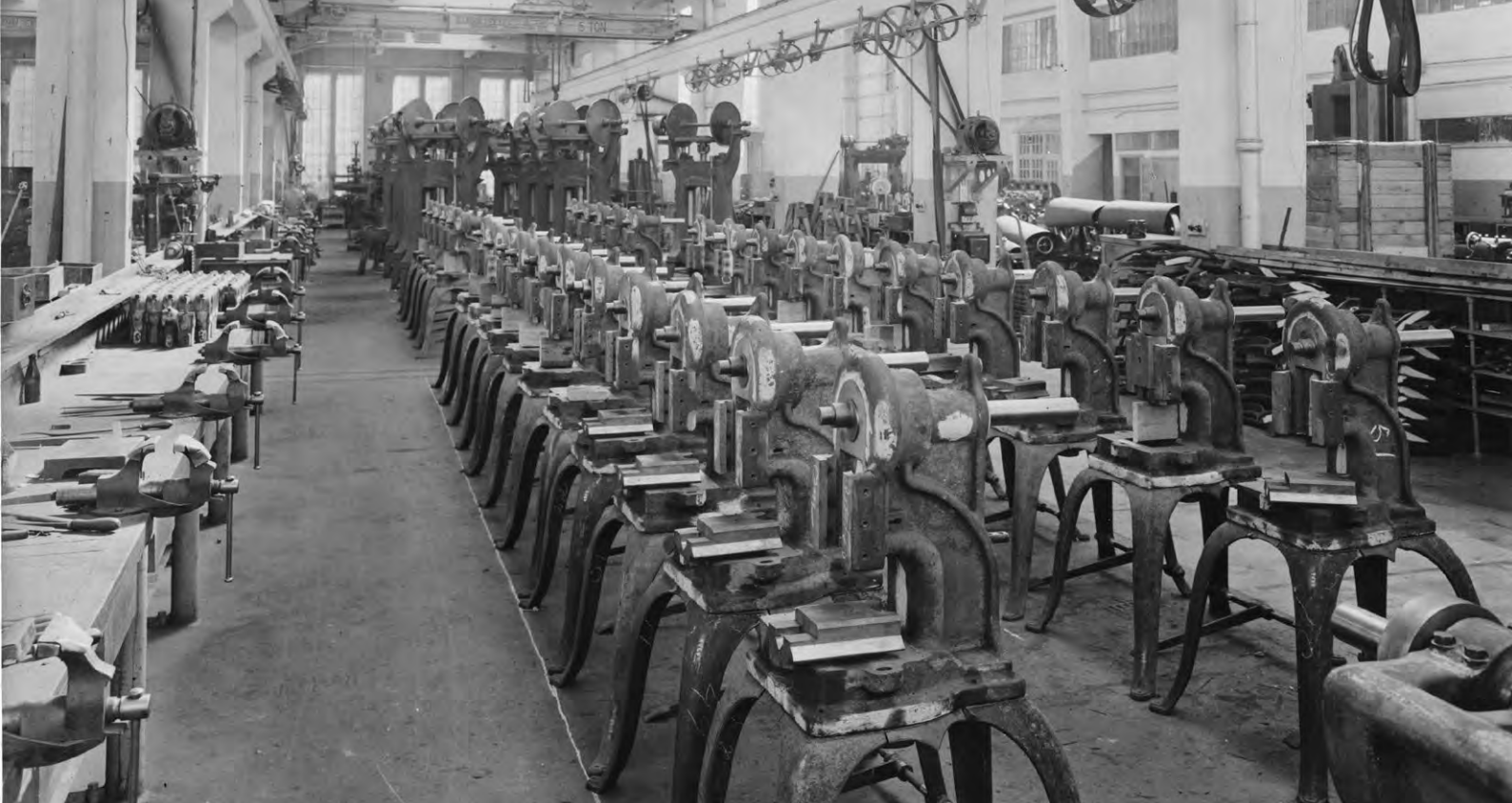
Munktells tillverkade olika sorters verkstadsmaskiner. Längst bort i bild syns montering av skruvpressar. I förgrunden syns excen-terpressar.
