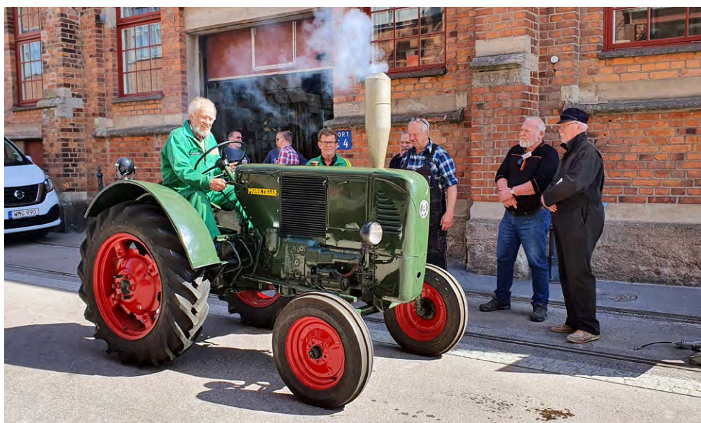
En BM-10 som är ett bra och populärt exempel på en tvåtakts tändkulemotor startades också. Bakom ratten sitter Anders Eskilsson från Odalmannens museum.
