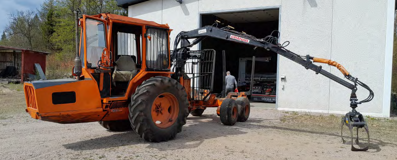
Ödbjörn uppställd utanför garaget. Kranen har bra räckvidd och är utrustad med en tvåhastighetsvinsch.
