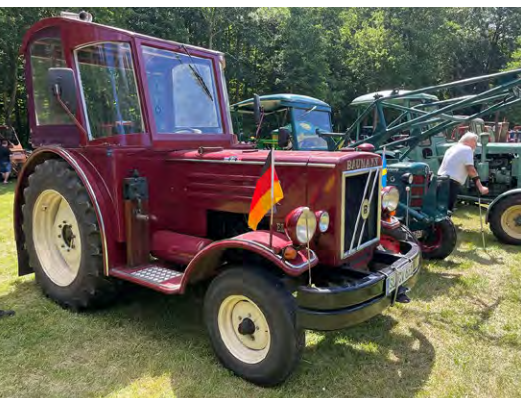
Tre besökare från Tyskland. Närmast en Bauman som är ett hemmabygge med en luftskyls Deutz dieselmotor.
