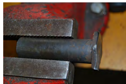
Modifierad M20 bult som sprint till styrkolv.
