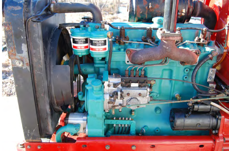
Efter ingrepp. Under insprutningspumpen syns centralen för smörjning av styrning och pendlning.
