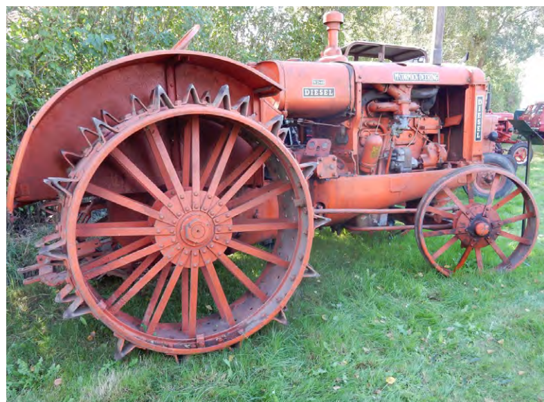
McCormick-Deering WD 40 Diesel tillverkades mellan 1935 och 1940 i USA. Den heter "Diesel" men på bilden syns tydligt både förgasare och magnet. Motorn kom från IH och är av typ Hesselman, alltså startas på bensin och slås över till diesel när den blivit varm.
