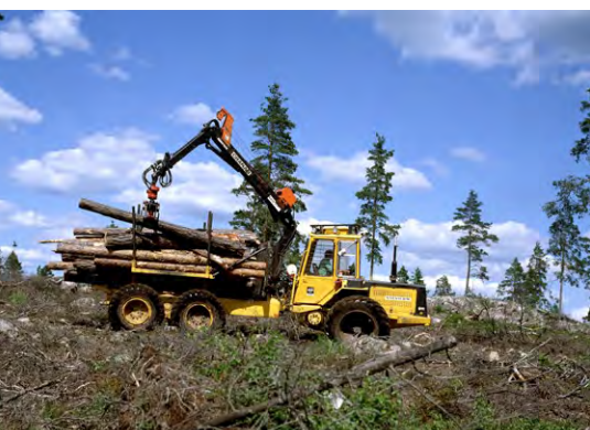
Volvo BM 9111 med kugghjuldriven boggi.
