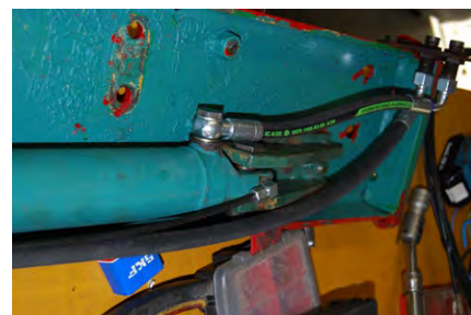
Styrkolv med ny sprint och slang. Undre slangen för centralsmörjningen av sprinten.
