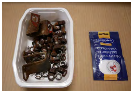
Blandning 1. Skruvar och fästen med rost, färg och olja.
