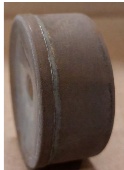
Här syns tydligt att locket på flottören är konkavt istället för konvext.
