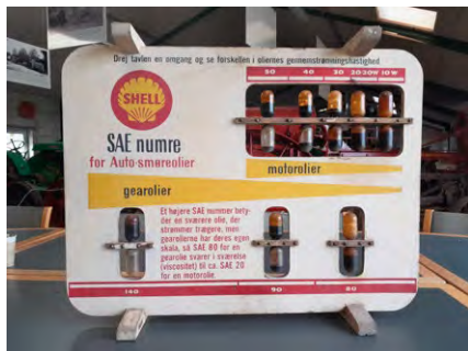
På denna tavla kan man praktiskt jämföra skillnaden mellan olika oljors viskositet.
