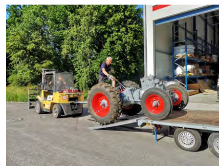
Traktorn hämtas efter blästring och zinkprimad.
