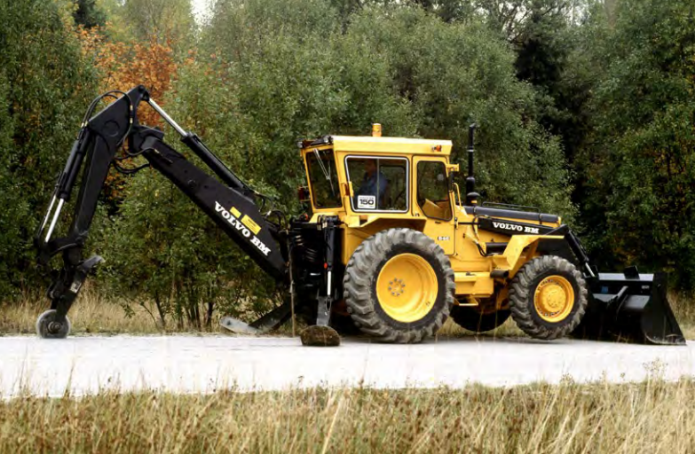
Grävlastare Volvo BM 646 försedd med asfaltsskärare.
