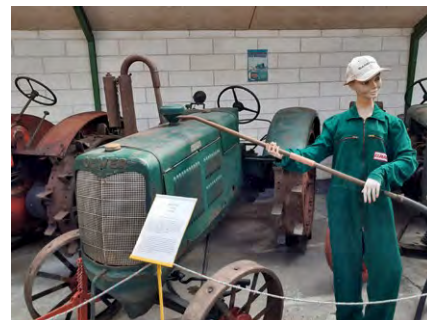
Ett ovanligt tillbehör. En "högtryckstvätt" som anslöts till avgasröret och gav varmvatten och högre tryck.
