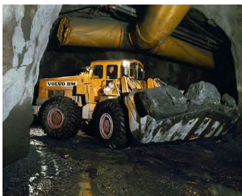
Hjullastaren Volvo BM 1641 U med lågbyggd hytt.
