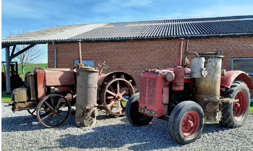
En BM 25 och en T 41 som bägge byggs om till gengasdrift.
