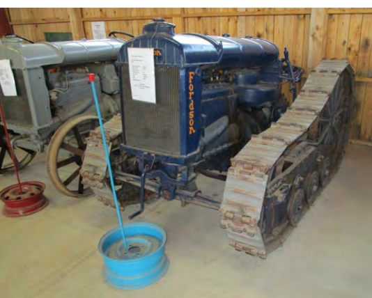
Fordson med band från Åbjörn Andersson i Svedala. Banden tog så mycket kraft i anspråk att traktorn inte orkade med några tillbehör.
