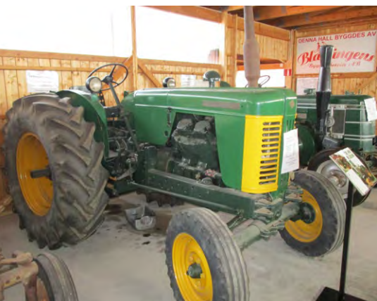
Turner 4V från England med V4 diesel-motor.
