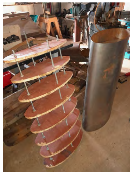
Inget jobb är främmande för Torben. Här har han tillverkat en tank på en egenhändigt byggd mall.
