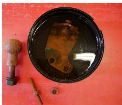
Blandning 2. Motorfäste, dragkula och gängstång med rost, färg och olja.
