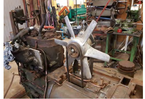
Den nya generatorm monterad inuti kylfläkten. Syns inte.
