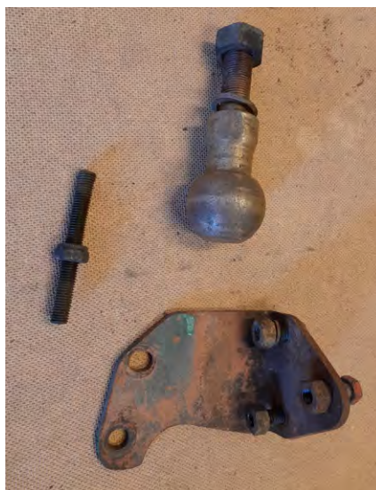
Blandning 2 efter 24 h. En del rost borta. All färg och olja kvar.
