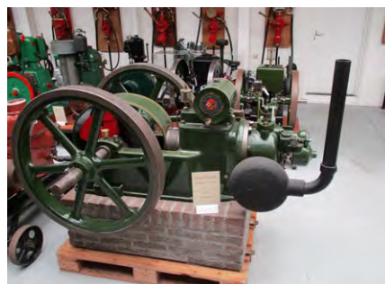
En av de första serieproducerade förbränningsmotorerna. Ursprunget var en ångmaskin som försetts med annat topplock.
