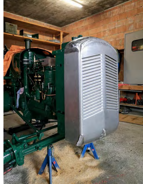
Den nya handtillverkade fronten provas.
