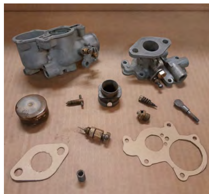
Förgasaren klar för montering.
