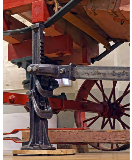
Bild från museet. Domkraften användes för att rikta upp tröskverk.
