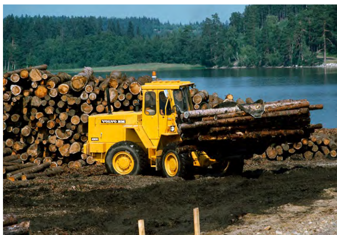
Den första i en ny generation moderna ramstyrda hjullastare, Volvo BM 4300.
