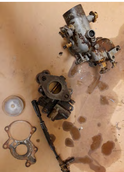
Förgasaren isärtagen och redo för tvätt. Här syns tydligt att packningen inte har hållit tätt.
