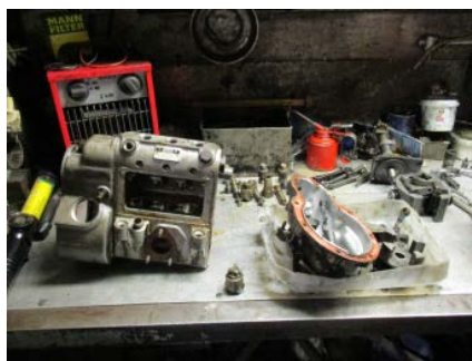
En nyss inkommen Injector-pump som antagligen skurit. Ägaren har själv försökt att ta isär pumpen men istället orsakat större skada.
