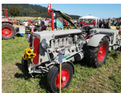
Här en lite mer ovanlig Hürlimann D100 från 1950. Det var den första Hürlimann med egenutvecklade, direktinsprutade dieselmotor. Motorn har fyra cylindrar med en sammanlagd volym av 4 l. Den ger 36 hk vid 1450 r/min. Traktorn är utrustad med slätterbalk och baktill en ovanlig hack för sönderdelning gräset.
