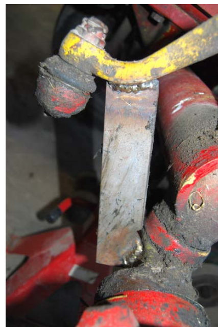
Här syns staget som Hannu svetsat fast mellan styrarm och hjulspindel.
