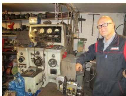
Detta är testapparaten för magneter, startmotorer och generatorer. Under armen på Lars står en Injector-pump färdig för leverans.
