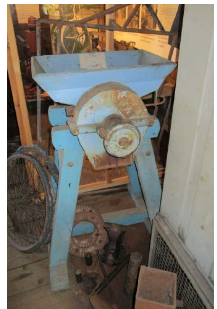
Här syns den gröpkvarn som SMV tillverkade. Gröpkvarn användes till att mala gröpe, dvs. foder till grisar.
