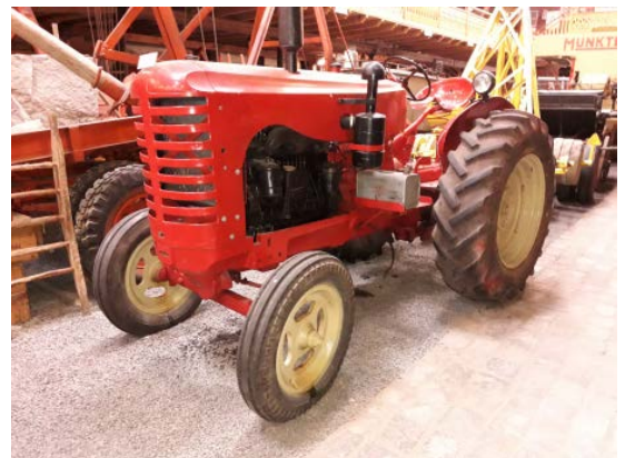
En ovanlig Massey Harris 744 med sexcylindrig Perkins dieselmotor.
