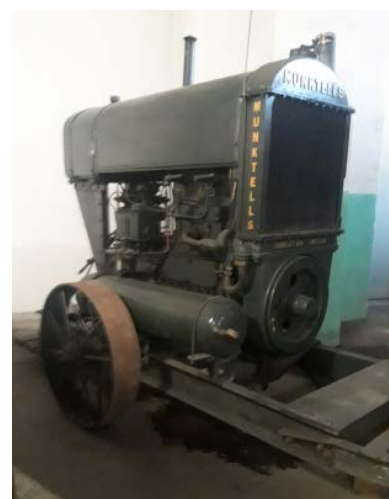
Motorn till 30 hk fanns även i stationärt utförande för drift av andra redskap och maskiner.
