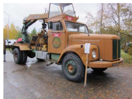
En ombyggd Scania 56 som användes för lastning av timmerbilar. Kranen skötes från den övre hytten.
