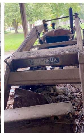
Traktorn är utrustad med en fransk Fauchaux frontlastare.
