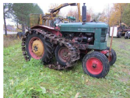
En BM Victor utrustad med halvband. För att få plats har framaxeln flyttats.
