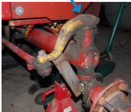
För att få bort glappet svetsas gärna styrarmen fast på hjulspindeln.
