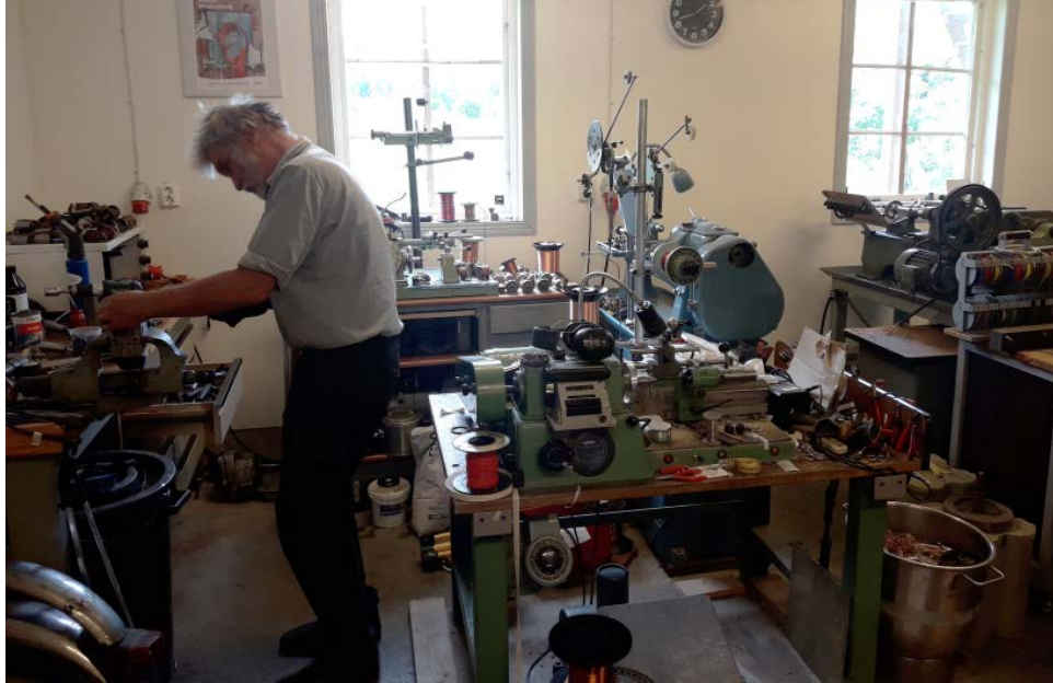
Mitt i bilden syns lindningsmaskinen. Trådspänningen måste ställas in exakt. Annars kan tråden gå av. Strax under klockan syns några av hjulen som tråden måste löpa över. Faktiskt sitter det tråd i maskinen men den är så tunn, 0,06 mm, så den syns inte.
