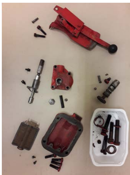
Längst upp i bilden och i mitten till vänster syns delarna till reglerstängens. Ovanför den vita plastformen syns spärrtappen, fjäder och kula samt stoppskrub med mutter. Längst ned till vänster syns returljefiltret och locket som det är monterat i.
