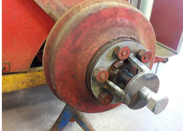
Avdragaren är på plats med alla hjulmuttrar monterade.
