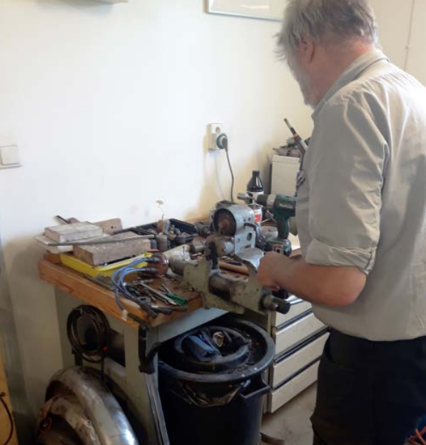
Olof har spänt upp magneten i skruvstycket, tagit av fördelarlocket och påbörjat undersökningen.
