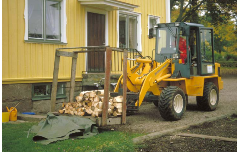
Zettelmeyer ZL602C Si, blev L30 i Sverige (med TP länkarms-system och Volvo BM redskapsfäste).
