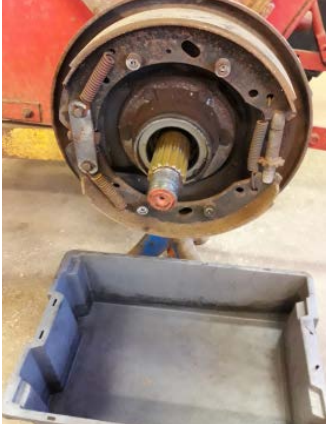
Det säkraste sättet att skydda sig mot bromsdammet är att tvätta bromsen. Använd mask, glasögon och handskar.
