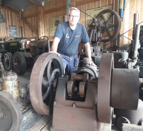
Urban med en av Munktells äldsta tändkulemotorer. I bakgrunden skymtar några av traktorerna.
