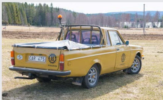
Lastgallret kommer från en VW Taro och flaköverdraget från en VW Caddy.
