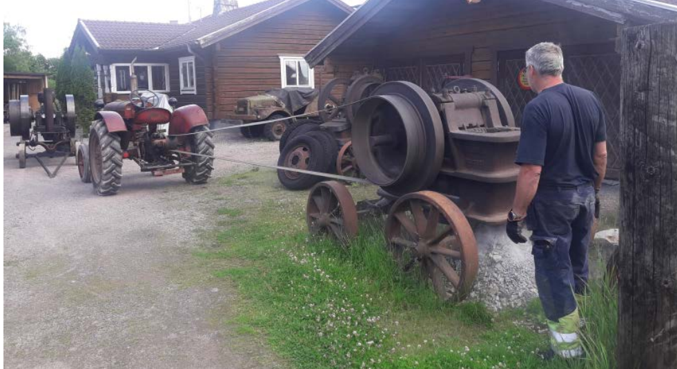
Urban demonstrerar sin Svedala stenkross. Som kraftkälla används en BM Victor.
