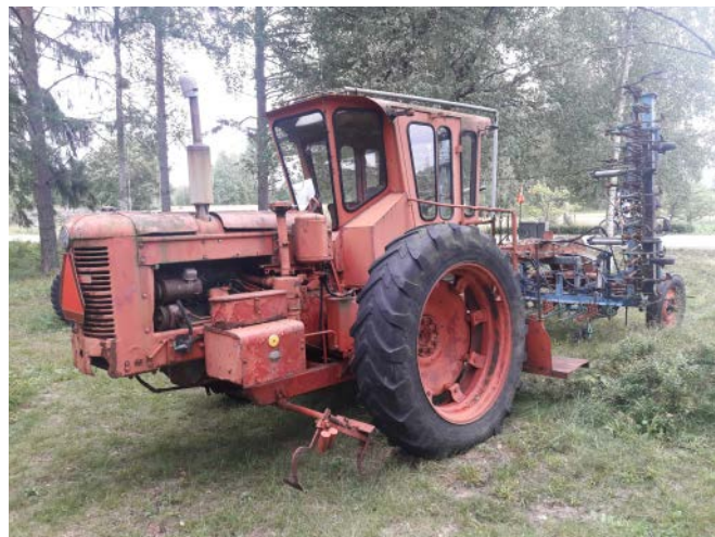
En radhacka byggd på en BM 36 från 1952. Lägg märke till hur fram och bakruta är vinklade för att undvika reflexer.
