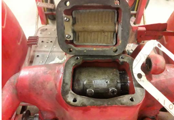
Här har locket ovanpå huset lossats. Nu syns metallfiltret och skruvarna som håller de yttre hävarmarna i den inre hävarmen. Glöm inte att knacka en ny packning.
