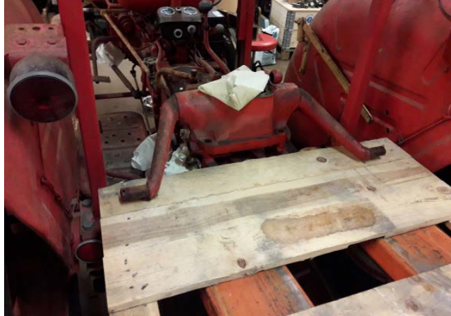
Här får hävarmarna vila mot en pall. Då ligger de kvar i sitt översta läge.
