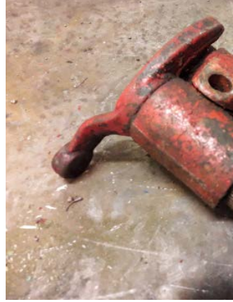
Bromshävvarmen med den fastrostade medbringaren.
