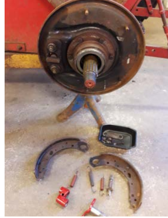
Bromsen och alla delar tvättade och klara för montering. Hävvarmen har fått lite färg på sig då den blev så svart vid värmningen.
