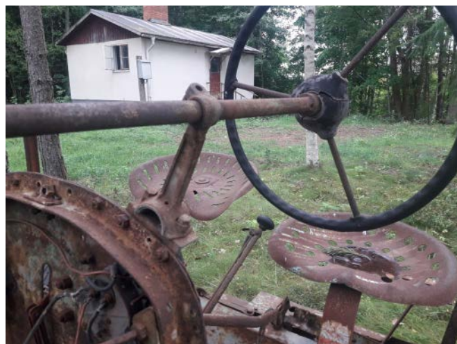
En vevstake kan vara bra till mycket. Här som ett stödlager.
