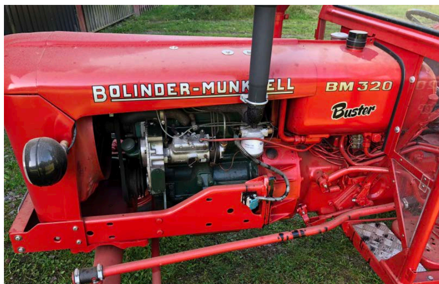
En närbild på den 3-cylindriga dieselmotorn.
