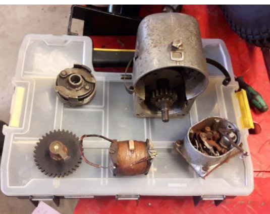
Magneten isärtagen. Längst upp till vänster syns impulsgivaren med sina vikter. Till höger själva huset. Undre raden från vänster syns rotor, lindning och lilla huset med brytare och kondensator.
