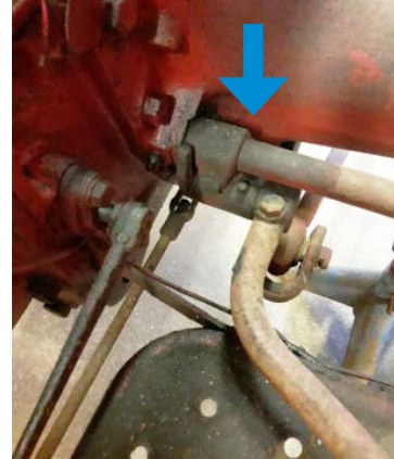
I mitten av bilden syns bromsnyckeln som är fäst i hävarmen. Styrbromspedalen och dragstången är fästa i medbringaren som i sin tur är fäst i hävarmen.
