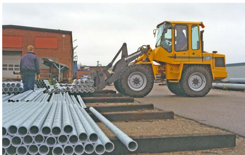
Zettelmeyer ZL802Si, blev L40 i Sverige (med TP länkarms-system och Volvo BM redskapsfäste).
