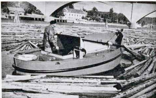
Traktorbåt 5,3x2,6 m. Dragkraft 700 kg
