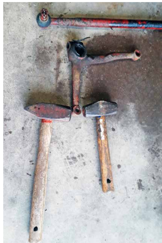
Även den mest motsträviga styrled lossas med hjälp av två släggor. En större som mothåll och en mindre att slå med.
