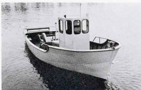
Varpbåt 8,0x2,7 m. Dragkraft 650 kg Dragkraft i spelet 2 500 kg
