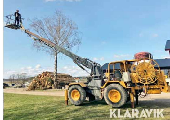
2. Vidare en skylift Volvo BM Bvb62 byggd på BMs fabrik i Braås. Fabrikat: Volvo BM Livab Modell: Bvb62 År: Okänd Serienummer: 50016 Drift: Diesel Maxlast: 2 personer Räckvidd: 14 meter Utrustad med: Kabelrulle
