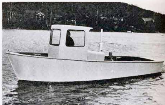
Bogserbåt 6,7x2,45 m. Dragkraft 700 kg
