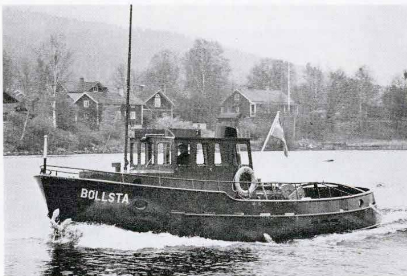
Varpbåt 8,0x2,7 m. Dragkraft 650 kg Dragkraft i spelet 2 500 kg
