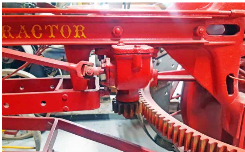
Närbild på ramstyrningen. Rattstången kommer in i bilden från vänster till vinkelväxeln.
