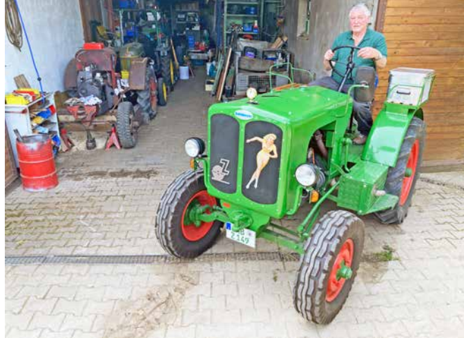
Ewalds Z1 behöver en ny motor, eftersom motorblocket är sprucket. I verkstaden ser ni en andra Z1, reservdelstraktor, där motorn snart är toppreoverad av Ewald. I bakgrunden en Bautz.
