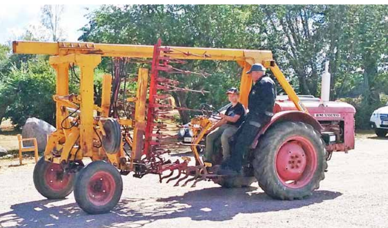
3. Först en radrensningmaskin för betodling.
