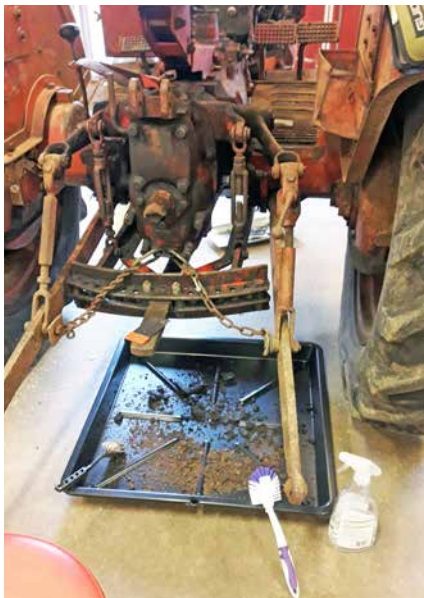
En tvättbalja för grillgaller är lämplig vid rengöring av traktorn.
