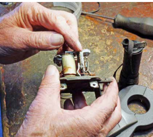
Först kollades reläets lindningar, motstånd och kontakter.
