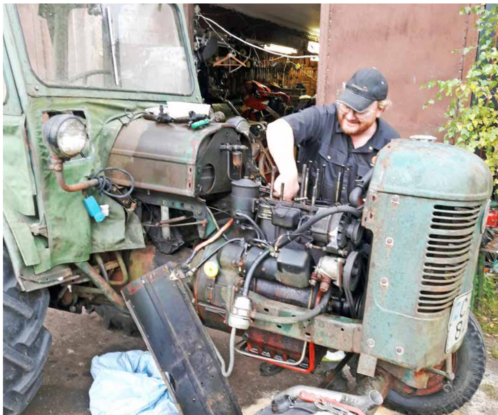
Här håller Börjesson att förbereda för den nya topplockspackningen.
