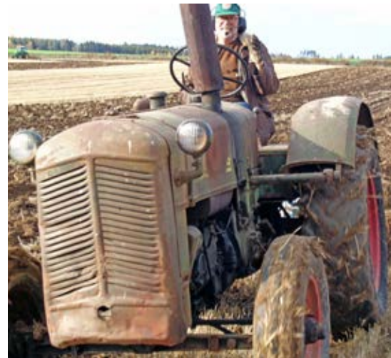
Per Johansson stortraktor från 1949, en BM 20 som är ombyggd till toppinsprutning på 43 hk.
