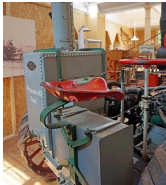
The Ivel med sina oskyddade kugghjul, kylartank till höger och motorhuv till vänster.
