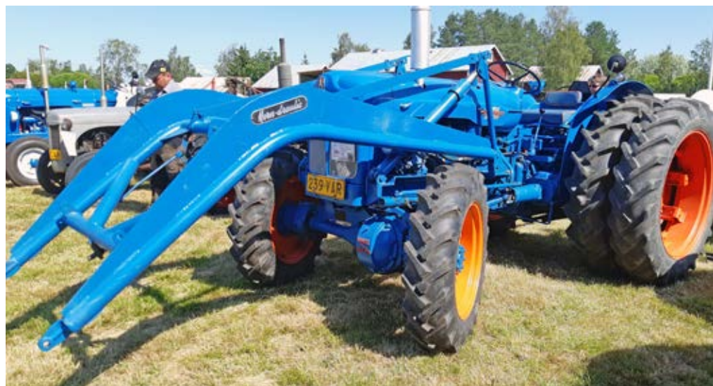
En Fordson Power Major med Manuel Roadless fyrhjulsdraft och Horn-drauliklastare.
