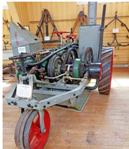
The Ivel med sina oskyddade kugghjul, kylartank till höger och motorhuv till vänster.
