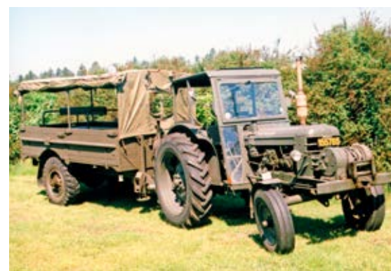
13. En svensk klassiker, Boxertraktorn med drivet Lihnellsläp hos Wendes i Kristianstad. Vinsch och el-broms ingår. Normalt tillkopplas en lätt pjäs efter släpet.
