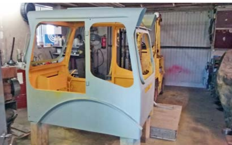
Här syns hytten spacklad, grundlackerad och delvis täcklackerad.
