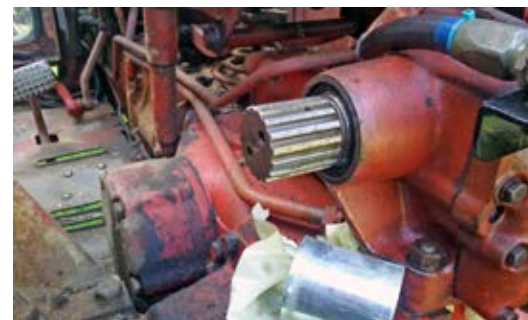
Här sitter nu packboxen i sitt rätta läge. I underkant av bilden syns den rörbiten som användes för att trycka dit packboxen.
