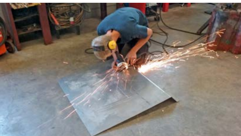
Här är Fredrik igång med att kapa till det nya golvet till hytten.
