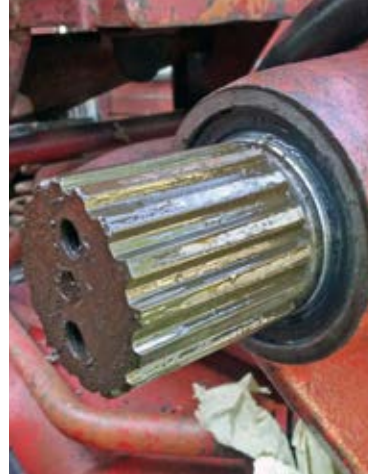
Med lyftarmen borta syns med låsbricka och den stora brickan borta.
