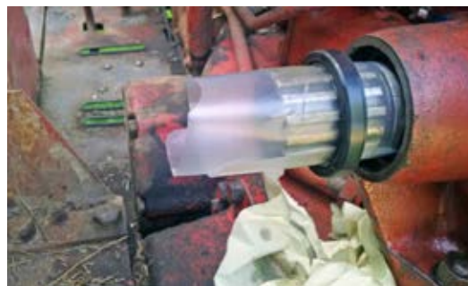
Här har splinsen "kläts in" med plast och packboxen är nästan i sitt läge.
