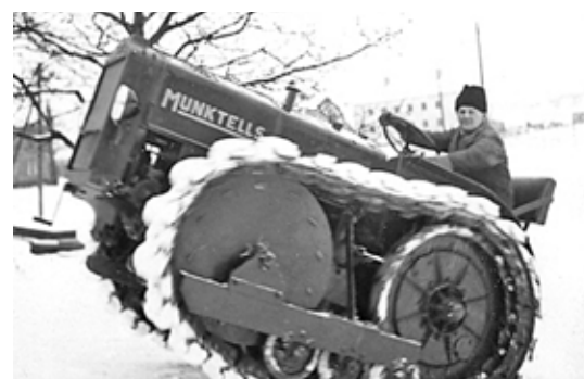
4. Munktells 25 tillverkades som försöksserie 1936 och provades i Boden. Vikt 4 ton. 2 cyl. råoljemotor på 35 hk.
