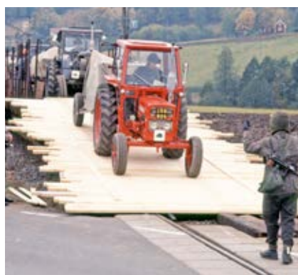
12. En "inkallad" civil Bustertraktor kör av järnvägsvagnen på tillfällig ramp uppbyggd på räls och sliprar med träplank överst.
