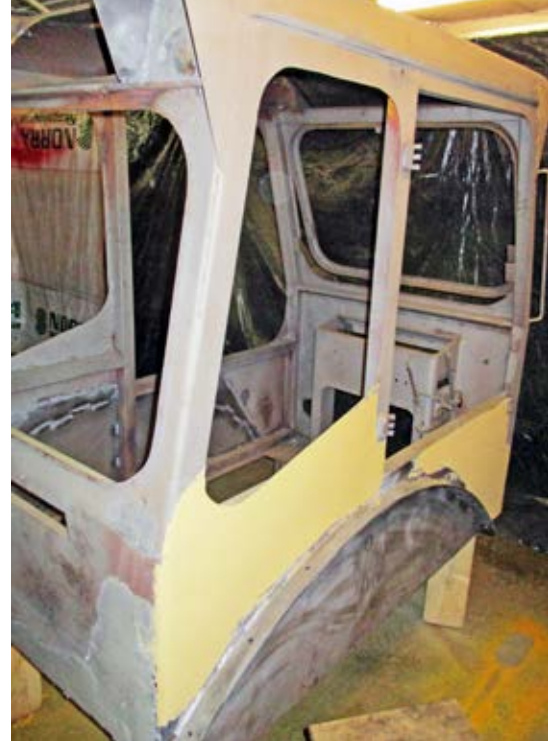
Hytten som är blåstrad och svetsad står på tur för lackering.
