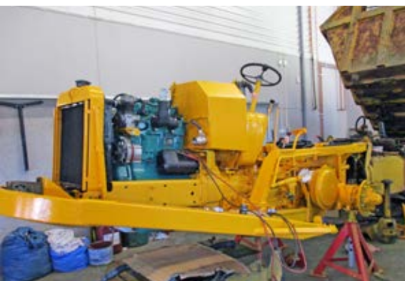
Motorn som är helrenoverad är på plats. Här syns också kompressorn.
