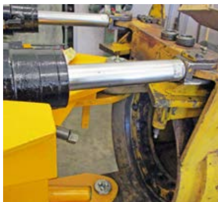
Ramleden är hopmonterad med nya expanderbultar som Fredrik tillverkat själv.
