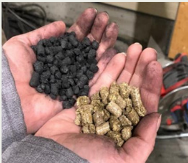
▲ V levé ruce je biouhel, který prošel pyrolýzou. Vpravo je vstupní surovina, v tomto případě peletovaný organický materiál.
