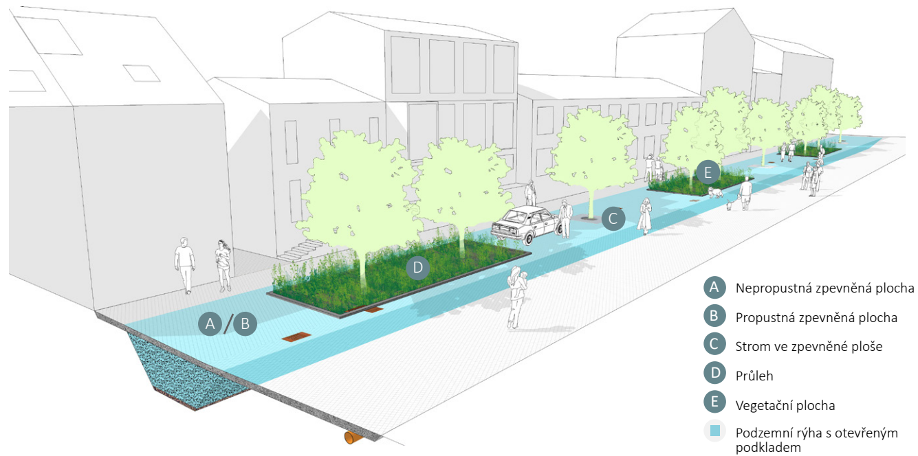
Obr. 12. Příklad BGG systému zabudovaného do flexibilní zóny. Modrá oblast znázorňuje podzemní rýhu, která se nachází podél celé ulice. Nad ní se volně střídají zpevněné plochy s průlehy, vegetačními plochami a stromy. Tato konfigurace vytváří řadu možností jak pro hospodaření s dešťovou vodou, tak pro flexibilní design ulice.
