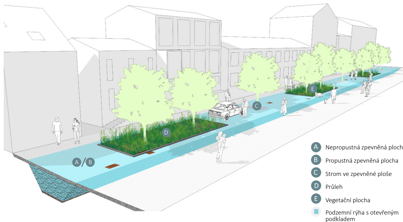
Obr. 2. Příklad městské ulice s BGG systémem umístěným ve flexibilní zóně (podélný pás mezi chodníkem a komunikací s kombinovanými funkcemi využití). Modrá oblast znázorňuje pás podzemní rýhy s otevřeným podkladem. Rýha se nachází podél celé ulice. Střídají se zde zpevněné povrchy, průlehy a prostor se zelení a stromy. Touto cestou lze s dešťovou vodou nakládat různými způsoby při současném zachování flexibility při navrhování ulice.
