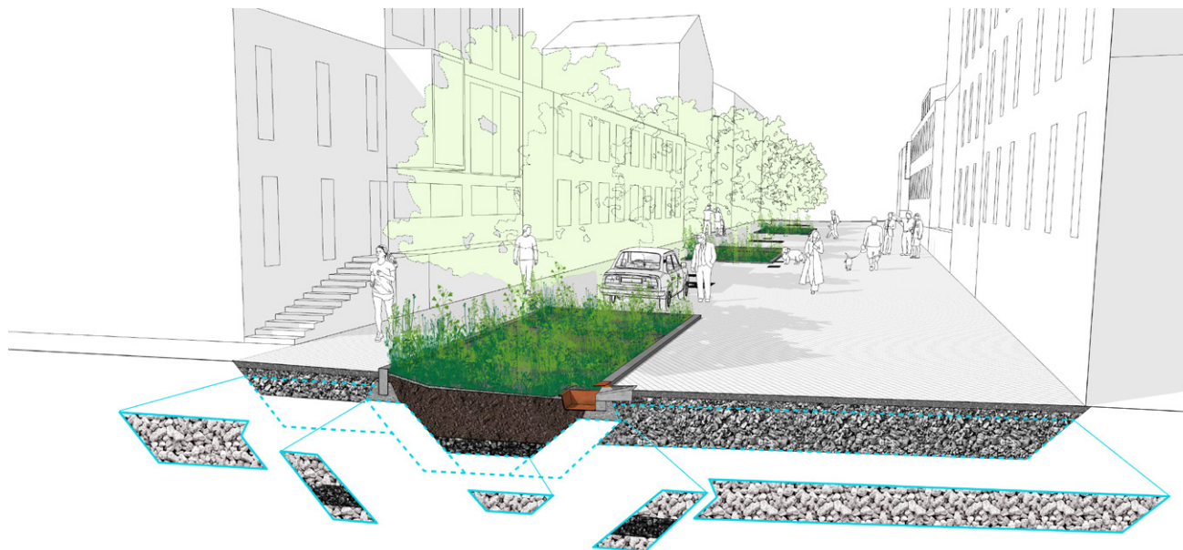
▲ Obr. 15. Podzemní rýhy s otevřeným podkladem lze rozšířit pod chodníky, cyklostezky a jízdni pruhy, aby se zvýšilo množství zadržené dešťové vody a velikost prostoru pro výsadbu. Určení velikosti a umístění otevřené podkladní vrstvy usnadňuje kombinování BGG systému s jinými typy pozemních staveb stejně jako plnění potřeb uspořádání v budoucnu.
