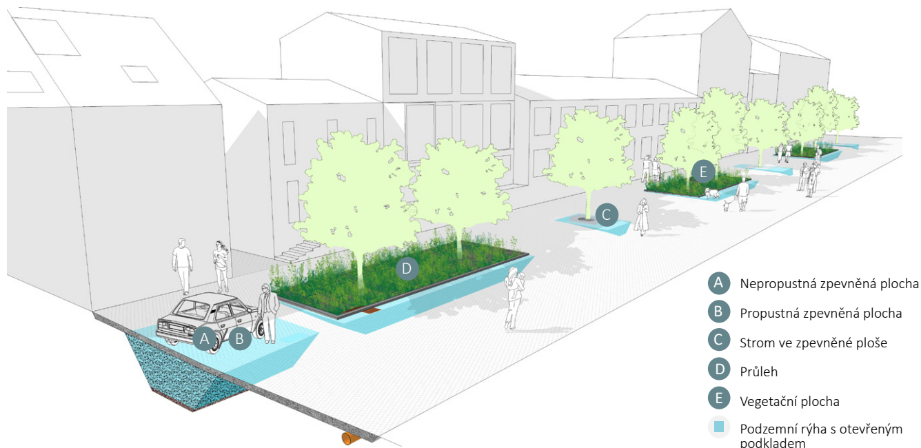
Obr. 11. Příklad ulice s BGG systémem tvořeným jednotlivými sekcemi podzemní rýhy pod každou konstrukcí zčásti. Plochy označené modře jsou jednotlivé úseky podzemní rýhy. Na těchto úsecích mohou být umístěny samostatné konstrukce jako jsou např. průlehy, vegetační plochy a prostory pro stromy ve zpevněných plochách. Výběr jednotlivých povrchových konstrukcí je na projektantovi, což BGG systému dává flexibilitu. V tomto případě je retenční funkce a funkce zásobování vegetace vodou v podzemní rýze z části omezena.
