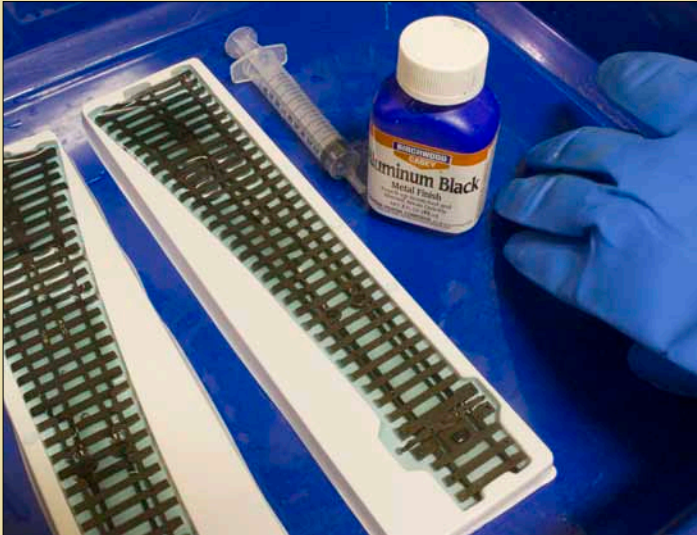
KJEMI: Gjør som jeg sier, ikke som jeg gjør. Sverting beregnet for aluminium fungerer også på nysølv, men soter mer enn sverting som er beregnet for formålet. Vi anbefaler Micro Engineerings svertevæske.
